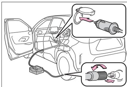
**23** コンプレッサーのスイッチを数秒間ONにしてから再度OFFし、空気圧を確認する
