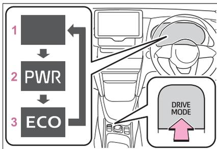
ドライブモードセレクトスイッチを押すたびに、ノーマルモード、パワーモード、エコドライブモードの順で切りかわります。
