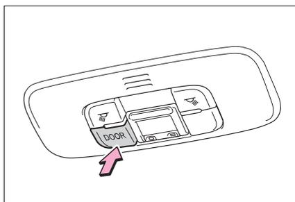
ドアの開閉に連動してランプの点灯・消灯を切りかえる
