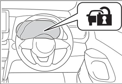
パワースイッチを OFF にすると、システムの作動を知らせるためにインジケーターが点滅します。
