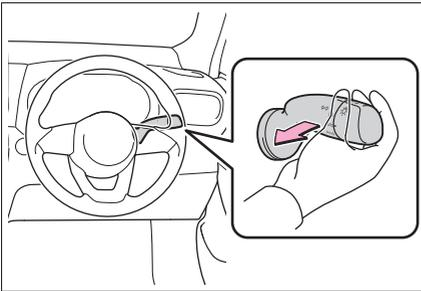
以下の操作でヘッドランプが消灯します。
