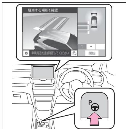
3 “MODE” スイッチが表示されたときは、スイッチを押してメモリ機能に切りかえる。
