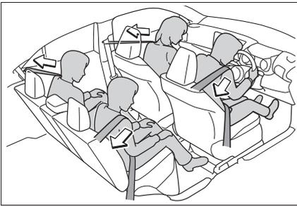
前方・側方から強い衝撃を受けたとき、シートベルトを引き込むことで適切な乗員拘束効果を確認します。
