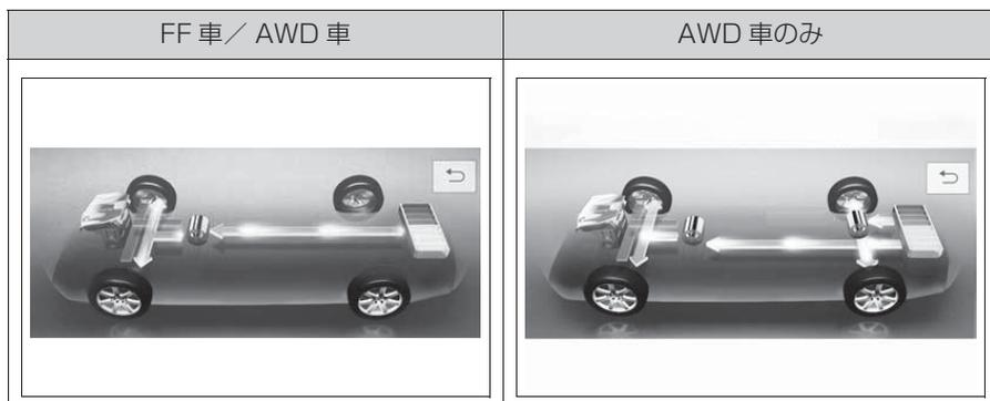
● ガソリンと電気の両方のエネルギーで走行しているとき
