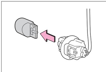
5 電球とソケットを取り付けるときは、取りはずしたときと逆の手順で取り付ける
