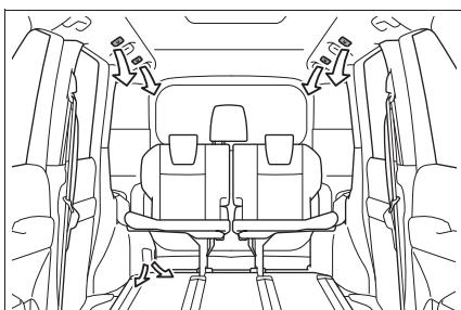
■ 風向きの調整と吹き出し口の開閉（天井吹き出し口）
