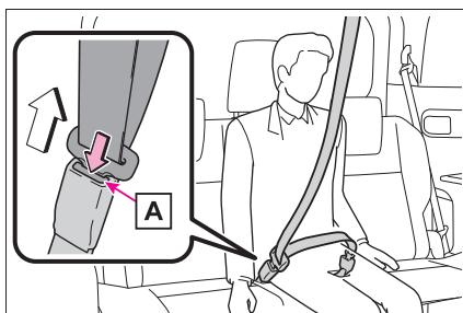
**2** メカニカルキー（→P.86）、またはプレート B をバックルの切り欠きに挿し込み、ベルトを分離する
