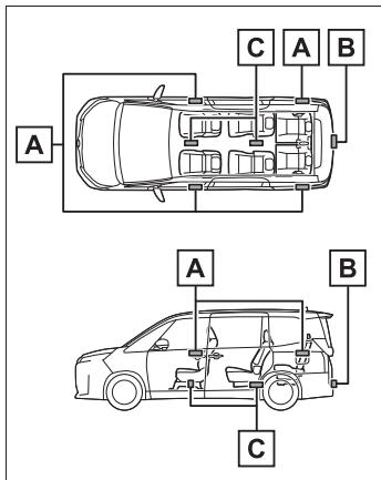
**A** 車外アンテナ**B** 車外アンテナ（バックドア）**C** 車室内アンテナ（車内）
