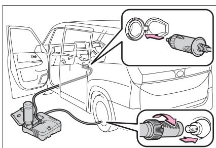
**20**コンプレッサーのスイッチを数秒間ONにしてから再度OFFし、空気圧を確認する
