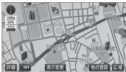
3個以上のGPS衛星からの電波を受信して、自車の現在地を測定することです。本機では3個以上のGPS衛星の電波を受信して測位可能な場合に、現在地画面上の左上隅に「GPS」を表示します。（メニュー画面、設定や登録の画面では、「GPS」は表示しません。）
