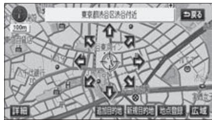
**6** **目的地セット**（**新規目的地**、**追加目的地**）にタッチしたとき、高速道路や橋、トンネルなどの付近では、目的地を設定する道路の種類を選ぶ画面が表示されることがあります。
