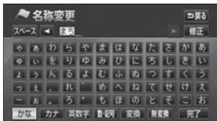
**4** **変換**にタッチしたときは、次に表示された画面（変換するリスト）で、入力する漢字、または熟語にタッチします。
