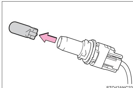
**3** 電球を交換し取り付ける
