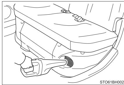
「駆動用電池の冷却部品のメンテナンス必要 取扱書を確認」が表示されたときはフィルターが目づまりしていることが考えられます。フィルターを清掃してください。
