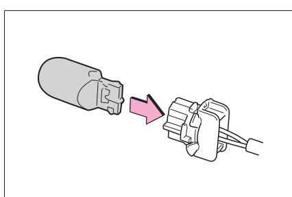
**5** ソケットを取り付ける
