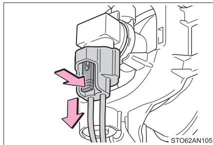
**6** ソケットを取りはずす
