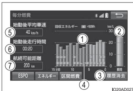
平均燃費はパワースイッチを ON モードにしてからと、前回走行時で色分けして表示されます。
