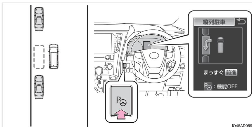
2 道路（または路肩）と平行で、駐車車両との間隔が約1mの位置に車両を移動させ、まっすぐ前進する
