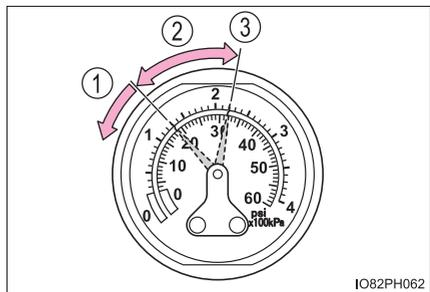
22 コンプレッサーのスイッチをONにして指定空気圧まで空気を充填し、再度、約 5km 走行後にあらためて手順 20 から実施する
