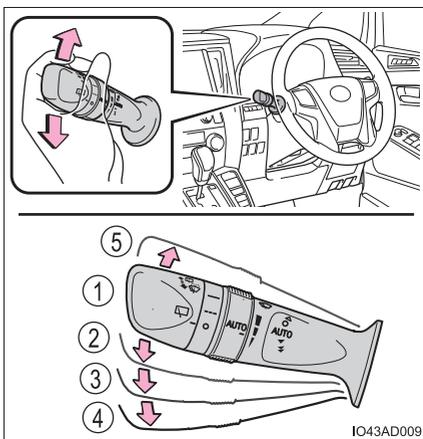
「AUTO」AUTO モードが選択されているときは、次のようにツマミをまわして、雨滴センサーの感度を調整できます。
