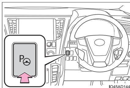
パワースイッチが ON モード、シフトレバーが P、R 以外で車速が約 30km/h 以下のとき、IPA スイッチを押すごとに、次のように機能が切りかわります。
