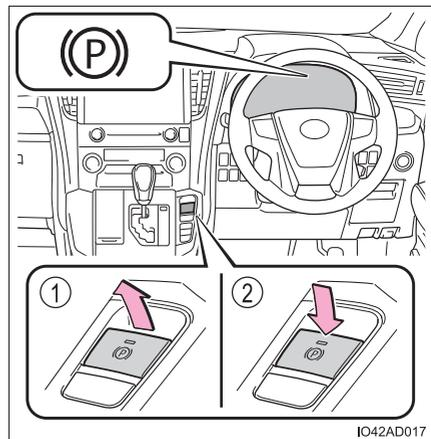
パーキングブレーキ表示灯が点滅した場合は、再度スイッチを操作してください。(→ P. 593)
