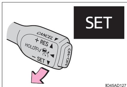
**通信利用型レーダークルーズコントロール（ITS Connect 装着車）**
