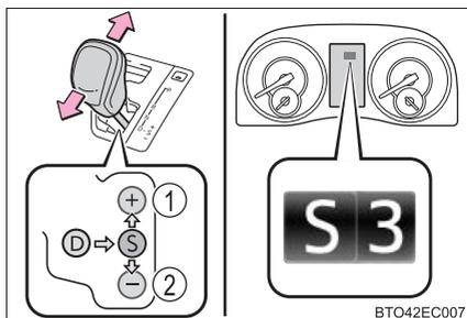
S ポジションへ操作したときの初期シフトレンジは車速に応じて 5 レンジもしくは 4 レンジに設定されます。ただし、D ポジションにて A-SHIFT 制御中はそれに従い、初期のシフトレンジが 3 レンジになる場合があります。(→ P. 222)
