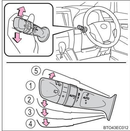
「AUTO」AUTO モードが選択されているときは、次のようにツマミをまわして、雨滴センサーの感度を調整できます。
