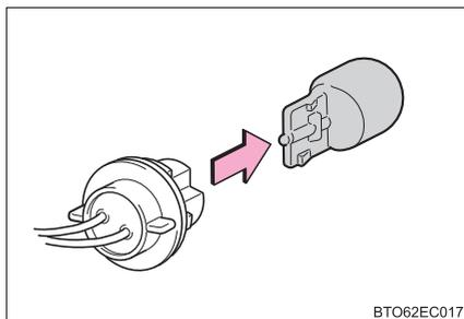
4 新しい電球を取り付け、ソケットをまわして取り付ける
