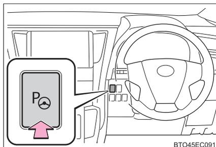
エンジンスイッチがイグニッション ON モード、シフトレバーが P、R 以外で車速が約 15km/h 以下のとき、IPA スイッチを押すごとに、次のように機能が切りかわります。
