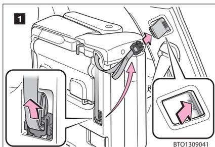
1 シートクッション裏側にあるシート固定ベルトを取り出し、ロック部に挿し込みます。
