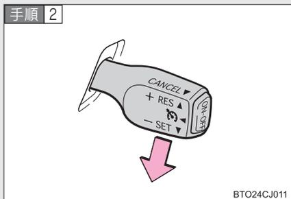
希望の速度まで加速／減速し、レバーを下げた速度を設定する。
