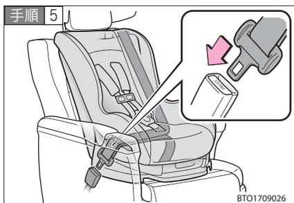
チャイルドシートにシートベルトを取りつけ、プレートをバックルに“カチッ”と音がするまで挿し込む。ベルトがねじれていないようにする。
