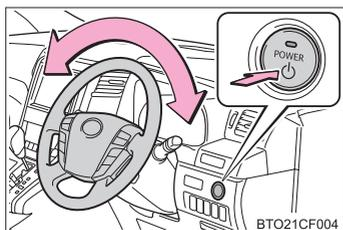
ステアリングを左右に動かしながら、“パワー”スイッチを押してください。
