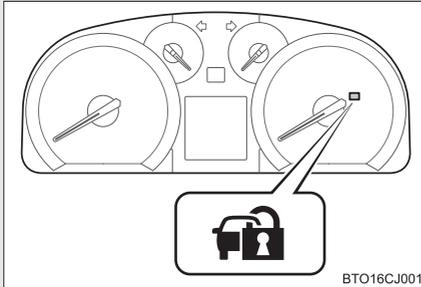
“エンジンスタートストップ”スイッチ<“パワー”スイッチ>をOFFにすると、システムの作動を知らせるためにインジケーターが点滅します。
