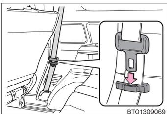
シートベルトを使用しないときは、シートベルトクリップに挟み、プレートをクリックプに押し込んでください。
