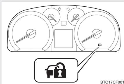
ドア・バックドア・ボンネットを閉めスマートエントリー&スタートシステム、ワイヤレスリモコンを使って施錠します。30 秒以上経過すると、自動的に設定されます。
