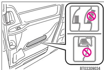
スライドドアのドアポケットには、雑誌などをドアポケットからはみ出した状態で収納しないでください。また、ドアポケットが変形するような大きいものを入れないでください。スライドドアの開閉のさまたげになるばかりでなく、開閉の際にボデーまたはドアポケットに傷がついたり、故障につながるおそれがあります。
