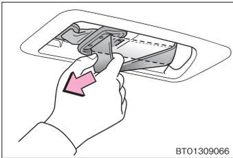
シートベルトとホルダーの間に指を入れ、ベルトを矢印の方向に強く引いてから離すと引き出すことができます。
