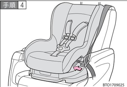
シートベルトを引き出し、ねじれがないか確認しながら、シートベルト通し位置に通す。
