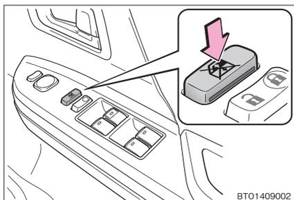
スイッチを押して運転席以外のドアガラス、リヤムーンルーフ\*を作動不可にする
