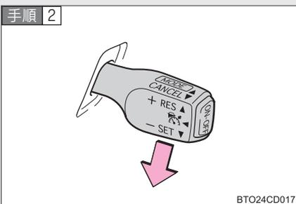
希望の速度まで加速／減速し、レバーを下げ、速度を設定する。
