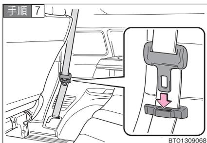
8 人乗り車は、セカンドシート左右席のシートベルトをシートベルトクリップに挟み、プレートをクリップの穴部に挿し込む。
