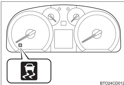
VSC・TRC・ABS が作動しているときは、スリップ表示灯が点滅します。
