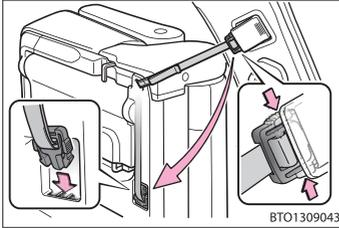
シート固定ベルトのツメを押してはずし、シートクッション裏側に格納します。
