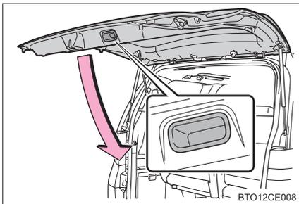
バックドアグリップを持ってバックドアを引き下げ、必ず外から押して閉めてください。
