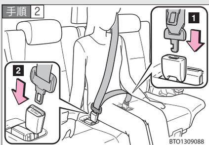
プレートをバックルに挿し込む
