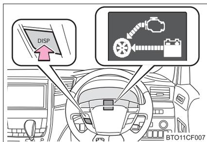
“DISP” スイッチを押し、エネルギーモニターを表示させる
