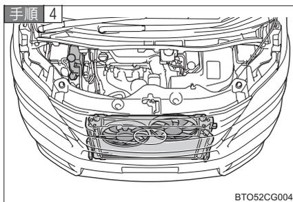
ハイブリッドシステムが十分に冷えてから、冷却水の量やラジエーターコア部（放熱部）の冷却水もれを点検する。
