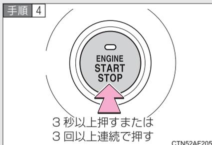
“エンジン スタートストップ”スイッチ < “パワー”スイッチ > を 3 秒以上押し続けるか、素早く 3 回以上連続で押してエンジン < ハイブリッドシステム > を停止する。
