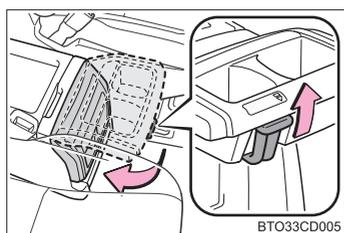
格納するときは、カップホルダー下部のレバーを引きながら下に回転させます。
