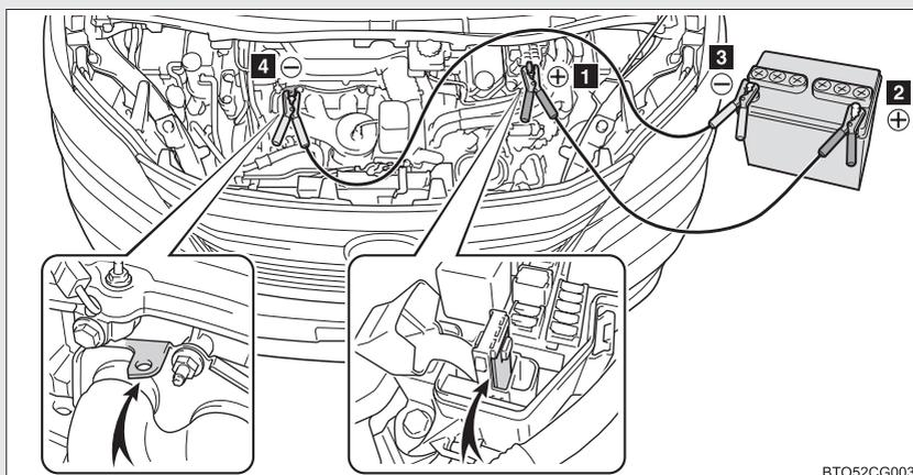
手順 5] 救援車のエンジンをかけ、回転を少し高めにして、約 5 分間自車の補機バッテリーを充電する。
