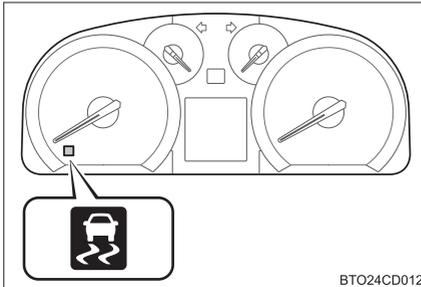
車両が横すべりしそうになったとき、前輪が空転したとき、ヒルスタートアシストコントロールを作動させ坂道発進をしたときは、VSC、TRC、ヒルスタートアシストコントロールの作動を表示するためにスリップ表示灯が点滅します。
