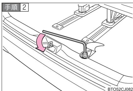
ホイールナットレンチを使用し、ボルトを応急用タイヤ格納具がフックから取りはずせるぐらいまでゆるめる。
