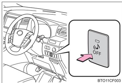
OFF にするには、“パワー” スイッチが ON モードのとき、スイッチを押す
