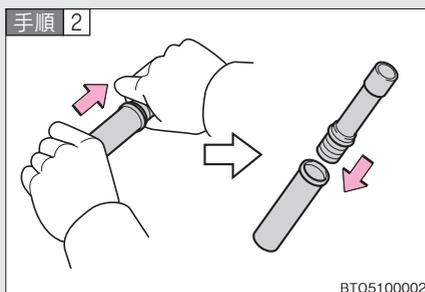
本体を回しながら抜き、本体を逆さにして挿し込む。
