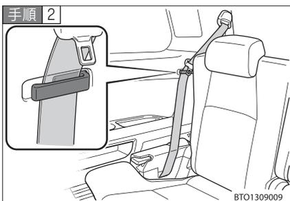
サードシート左右席のシートベルトをシートベルトクリップに挟む。
