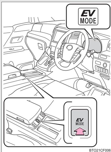
EV ドライブモードの ON・OFF を切り替える
