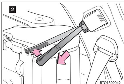
2 シートを手で押さえながら、シート固定ベルトを引っ張りシートを固定します。
