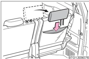
運転席側サードシート背面のファスナーを開けてヘッドレストを収納します。
