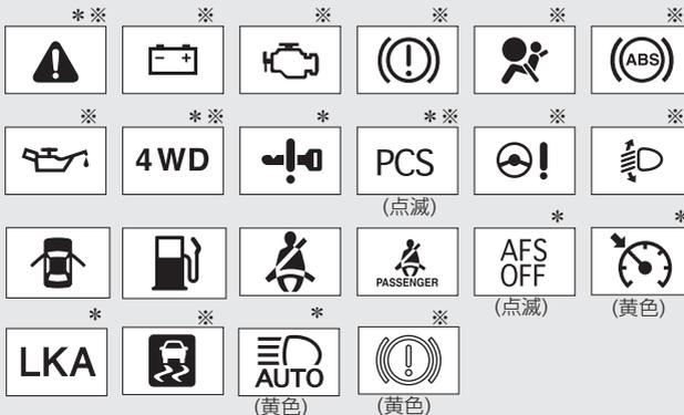
※作動確認のために“エンジン スタート ストップ”スイッチをイグニッション ON モード<“パワー”スイッチを ON モード>にすると点灯し、数秒後またはエンジン<ハイブリッドシステム>を始動すると消灯します。点灯しない場合や点灯したままのときはシステム異常のおそれがあります。トヨタ販売店で点検を受けてください。
