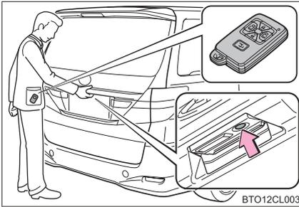
バックドアロックスイッチを押して施錠する
