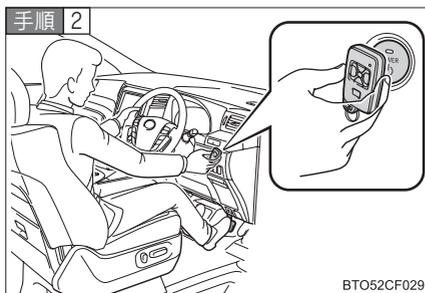
電子キーのトヨタエンブレム面で“エンジンスタートストップ”スイッチ<“パワー”スイッチ>に触れます。
