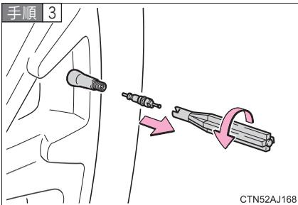
バルブコア回しでバルブコアを反時計回りにまわして抜き取る。
