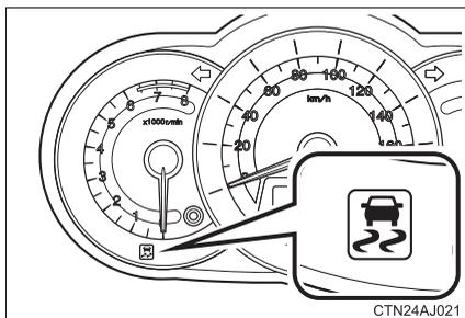
ダウンヒルアシストコントロールシステムが作動しているときは、スリップ表示灯が点滅します。このとき、制動灯とハイマウントストップライトが点灯しています。
