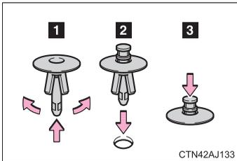
取りはずしたクリップを取り付けるときは、クリップを左図のように取り付けてください。
