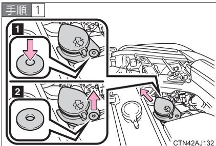
クリップをはずしウォッシャー液補給口の位置を移動する。
