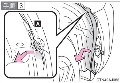
A 部を車両内側へ押しフェンダーライナーをフェンダーからはずし、フロントフォグライトのコンネクターが見える位置までフェンダーライナーをめくる。
