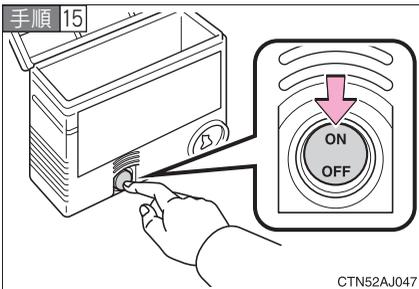
コンプレッサーのスイッチを ON にして、指定空気圧まで空気を充填する。
