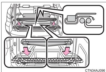
リヤデッキボードを開けてサイドデッキボードを取りはずし、トノカバーを収納する。
