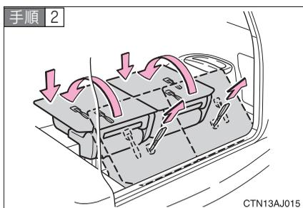
ストラップを引きながら、シート全体を前方へ押し出し、シート全体を押し下げてロックさせる。
