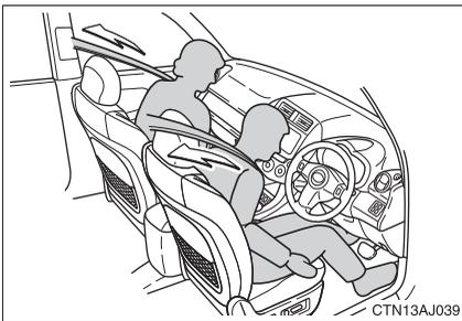
前方から強い衝突を受けたとき、シートベルトを引き込むことで適切な乗員拘束効果を確保します。
