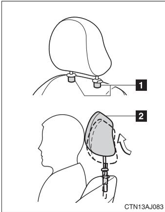
シートバックへの衝撃が弱い場合でもアクティブヘッドレストが作動することがあります。なお、解除ボタンを押さずにヘッドレストを無理に押し上げると、ヘッドレストの構造部品が出てきますが、故障ではありません。
