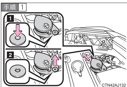
クリップをはずしウォッシャー液補給口の位置を移動する。
