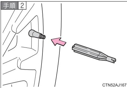
バルブコア回しの突起部をバルブに押しあて、空気を抜く。
