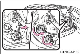
カバーをはずした後、ツメから配線ははずしてから、ソケットを取りはずします。
