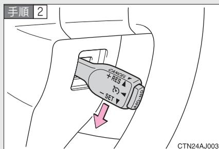
希望の速度まで加速／減速し、レバーを下げて設定する
