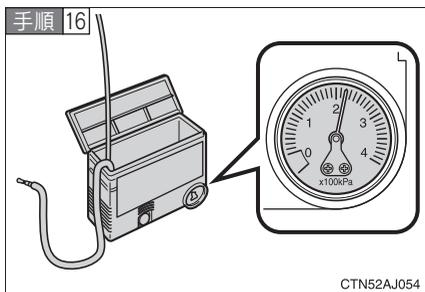
圧力計を確認しながら指定空気圧になったらコンプレッサーのスイッチを OFF にする。
