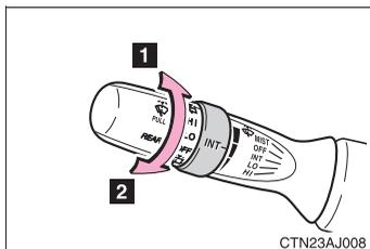
ツマミを回すと間欠作動の時間が調整できます。
