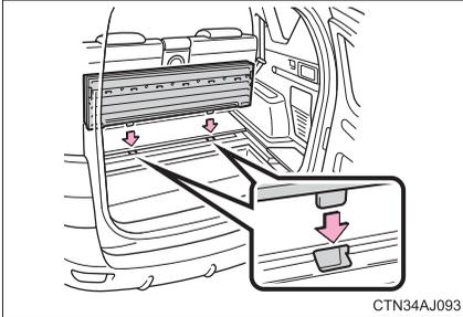
デッキアンダートレイのくぼみとデッキボードの凸部を合せて取り付ける。
