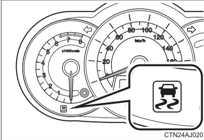
車両が横すべりしそうなとき、駆動輪が空転したときは、S-VSC、TRC の作動を表示するためにスリップ表示灯が点滅します。
