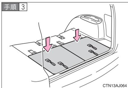
シートの前側を押し下げてロックさせる。
