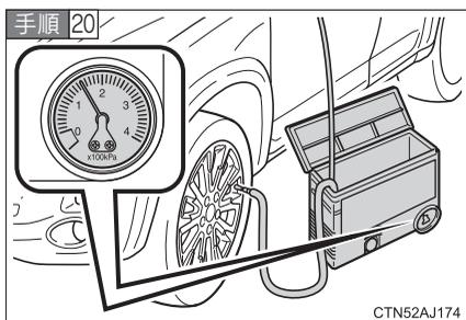
圧力計で空気圧を確認する。
