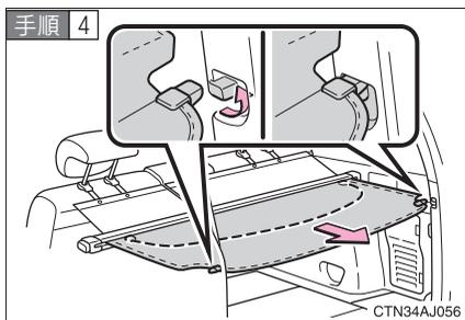
トノカバーを引き出し、カバー両側のフックを車両後方の左右の取り付け部に差し込む。
