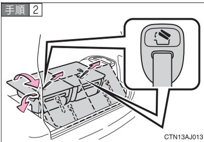
ストラップを引ながら、シート全体を車両後方へ引き上げる。
