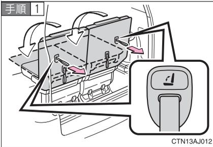
ストラップを引ながら、背もたれを前方に倒しロックさせる。
