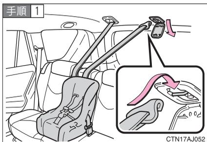
トップテザーアンカーにフックを固定し、テザーベルトを締める。
