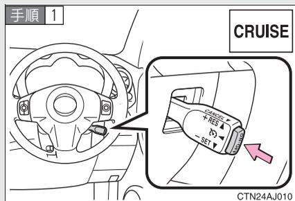
ON-OFFスイッチでシステムをONにする
