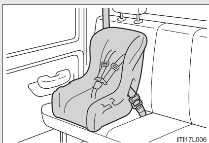
3 点式シートベルトによる取り付け (→P. 103)
