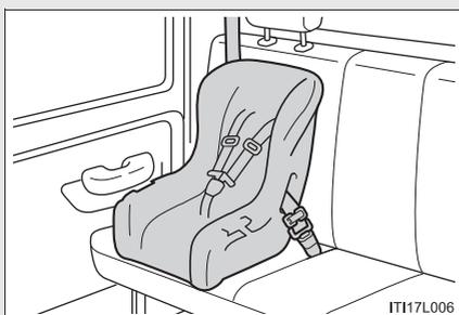
3 点式シートベルトによる取り付け (→P. 103)
