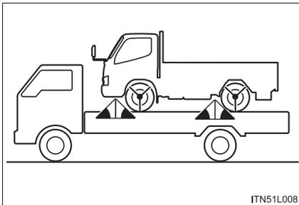
鎖やケーブルなどを使用して車両を固縛する場合は図に黒く示す角度が  $45^\circ$  になるように固縛する
