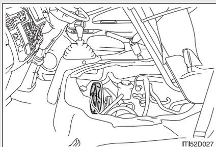
**手順 5** 冷却水が不足している場合は、冷却水を補給する（→P. 349）
