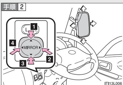
スイッチを操作してミラーの鏡面を調整する
