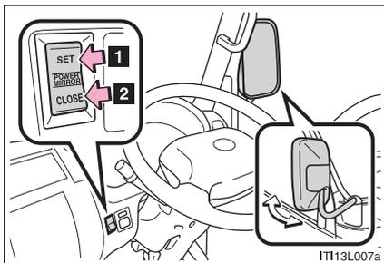
スイッチを操作してアウターミラーを格納する
