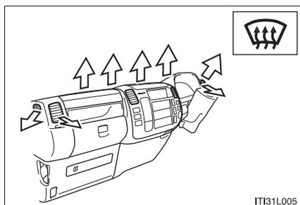
吹き出し口切り替えレバーを
