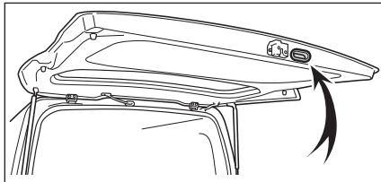
バックドアハンドルを持ってバックドアを引き下げ、必ず外から押して閉めてください。
