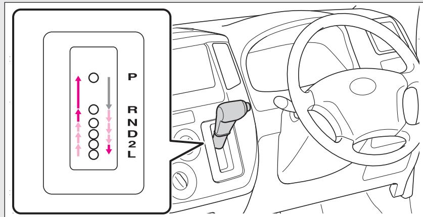
←エンジンスイッチが“ACC”または“ON”的状態で、ブレーキペダルを踏んだまま操作します。
