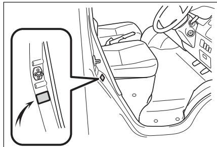
タイヤの指定空気圧は、運転席側のタイヤ空気圧ラベルで確認してください。
