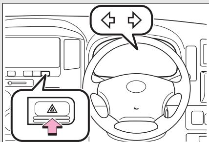
スイッチを押すとすべての方向指示灯が点滅し、もう一度押すと消灯します。
