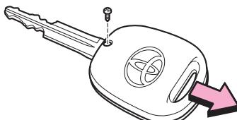
小さいプラスドライバーでネジをはずし、カバーを取りはずします。
