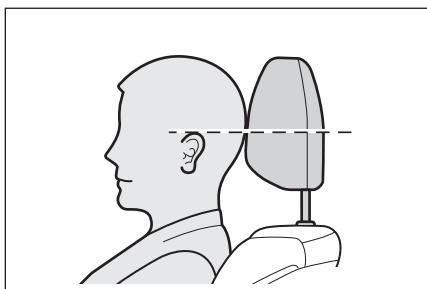
調整式ヘッドラストは、必ずヘッドラストの中心が両耳のいちばん上のあたりになるよう調整してください。
