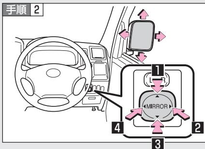
スイッチを操作してミラーを上下左右方向に調整する。
