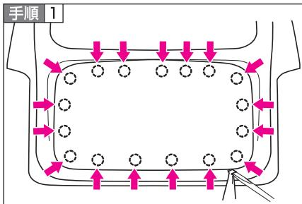
バックドアを開け、マイナスドライバーと当て布を使ってクリップの勘合をはずし、内張りをはずす。
