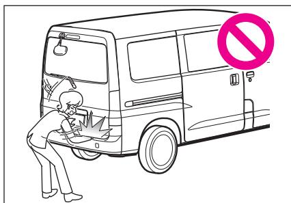
● 半開状態で使用すると、バックドアが落ちて重大な傷害を受けるおそれがあります。とくに傾斜地では、平坦な場所よりもバックドアの開閉がしにくく、急にバックドアが開いたり閉じたりするおそれがあります。必ずバックドアが全開で静止していることを確認して使用してください。
