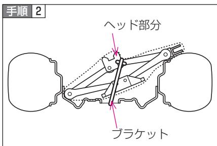
左図（横から見た図）のように、ジャッキのヘッド部分がブラケットに固定するように、ジャッキを締めつける。
