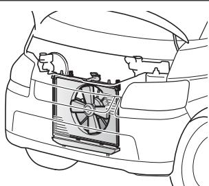
エンジンが十分に冷えてから、冷却水の量やラジエーターコア部（放熱部）の冷却水漏れを点検する。
