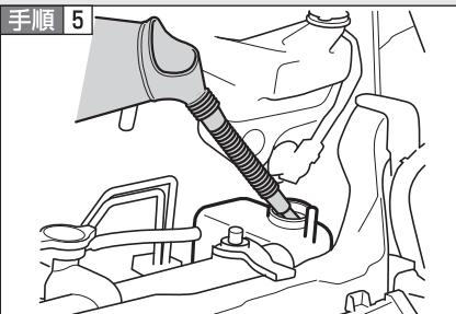
冷却水が不足している場合は、冷却水を補給する。（→P.216）
