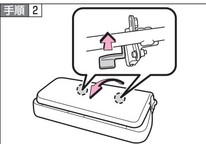
シート脚部のレバーを引いてロックを解除し、シートを持ち上げる。
