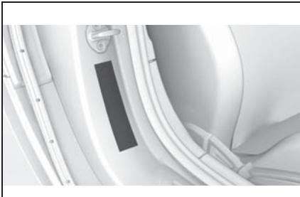
タイヤ空気圧規定値はドア ピラーのタイヤ空気圧ラベルに記されています。
