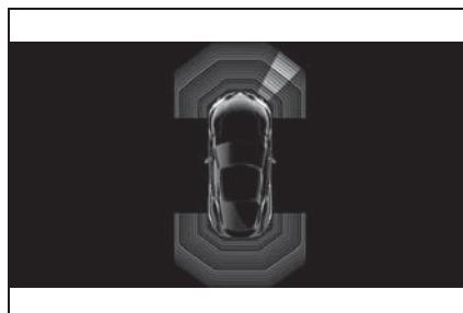
障害物への接近は、コントロールディスプレイに表示されます。さらに遠くの障害物は、信号音が鳴るよりも前の時点でそこに表示されます。
