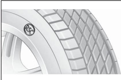
タイヤ側面部分に RSC-Runflat System Component と刻印されています。
