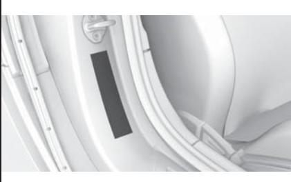
タイヤ空気圧規定値は運転席ドアのドア ピラーに記載されています。
