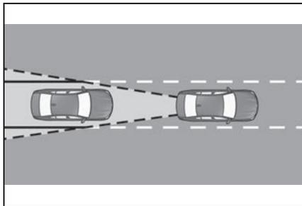
レーダー センサーは車両後方の空間をモニターします。
