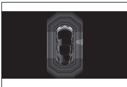
車両のサイド部を保護するために、車両の横側に障害物マークが表示されます。
