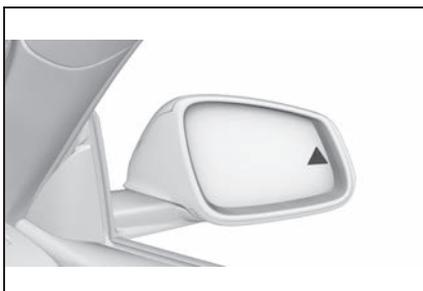
リア センサーによって車両が検知され、自車が後進すると、ドア ミラーの警告灯が点滅します。
