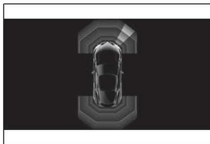
障害物への接近は、コントロールディスプレイに表示されます。さらに遠くの障害物は、ブザーが鳴るよりも前の時点でそこに表示されます。
