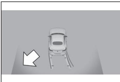
センサーによって車両が検知されると、クリアランスソナーの画面の緑の部分が赤く点滅します。
