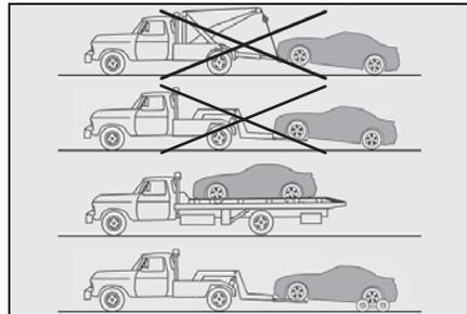
車両は、レッカー車を使用し、いわゆるアンダーリフトを使用するか、荷台上で、またはけん引ドリーを使用して移送してください。
