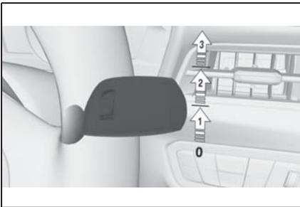
作動させる：レバーを基本位置から 1 回上方（位置 **1**）に押し下します。
