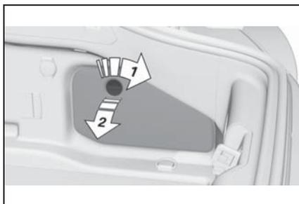
右サイド トリム パネルのカバーをロック解除し（矢印 1）、開けます（矢印 2）。
