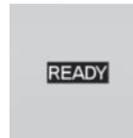
メーターパネルの表示は、アイドリングストップ機能が自動エンジン スタートの準備を完了していることを示しています。
