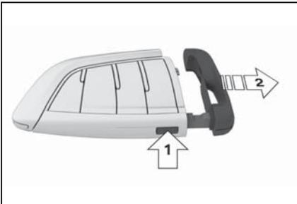
ボタン、矢印 **1**、を押し、内蔵キーを引き抜きます、矢印 **2**。
