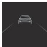
車両シンボルが点滅：システムの作動のための前提条件が満たされていないため。
