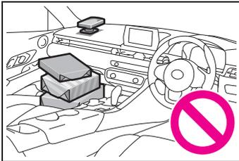
ステアリング ホイールのパッド部分やニー エアバッグの近くに、ステッカーなど、いかなるものも取り付けたり、貼り付けをしないでください。また、助手席エアバッグの近くに市販品アクセサリーや芳香剤などを置いたり足元に物を置かないでください。エアバッグが作動できなかつたり、エアバッグがふくらむときに取り付けしていたものが吹き飛ばされ、乗員の顔や体にぶつかりけがをするおそれがあります。
