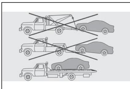
お客様の車両は、レッカー車を使用し、アンダーリフトを用いるか荷台に載せて輸送してください。
