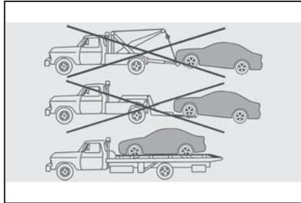
車両は必ず荷台に載せて移動してください。
