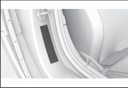
タイヤ空気圧規定値は運転席ドアのドア ピラーに記載されています。
