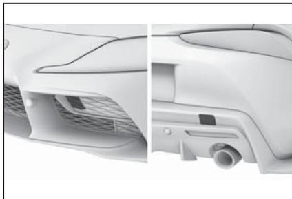
取付け口を出すために、カバーの縁のマーク部分を押ししてください。マークの代わりに開口部があるカバーの場合、開口部からカバーを引き出します。
