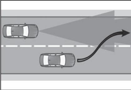
自車の車線に前走車が突然割り込んできた場合、状況によってはシステムは選択されている車間距離を自動的に確保できないことがあります。選択された車間距離は、状況によっては、トラックに速く近づく場合など、前走車との速度の違いが大きい場合にも確立できません。前走車を確実に検知している場合、システムは運転者に対してブレーキ操作または危険回避動作を要求します。
