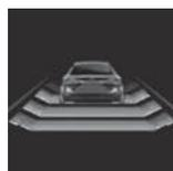
車両シンボルと距離バーが赤で点滅し、ブザーが鳴る：
