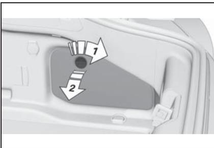
右サイド トリム パネルのカバーをロック解除し (矢印 1)、開けます (矢印 2)。
