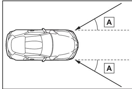
**SRS フロントエアバッグ / ニーエアバッグが作動する可能性が高いとき**
