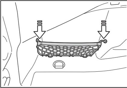
小物は左側のネットに収納できます。比較的大きな物を運ぶ場合は、ネットを下方に移動します。そのために、ネットの端をできる限り縁の側、ホルダー脇でつかみます。抵抗に逆らって動かすとスタートします。
