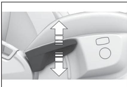
シートが希望の高さになるまで、レバーを何度か上に引くか、下に押しします。
