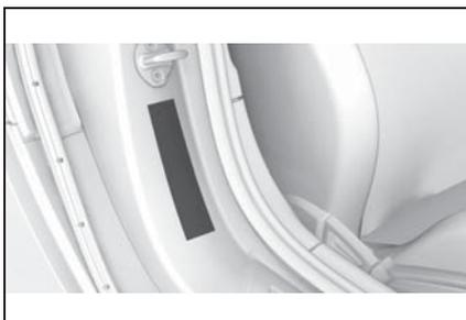
タイヤ空気圧規定値はドア ピラーのタイヤ空気圧ラベルに記載されています。
