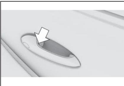
ドアが閉まっている状態で、ドアハンドルの溝の部分に指で約 1 秒間触れます。
