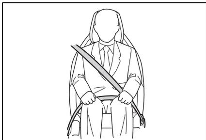
乗員保護の基本はシートベルトであり、エアバッグはシートベルトの補助装置にすぎません。シートベルトを正しく着用すれば、万一衝撃を受けたときでも身体がシートに確実に固定されるので、身体を他の部分にぶつかけたり、車外へ放り出されることもありません。そのため、全員がシートベルトを着用する必要があります。ただし、着用方法を間違えると、乗員保護機能が著しく損なわれます。以下の説明に従い、正しい乗車姿勢と正しいシートベルト着用方法を守ってください。
