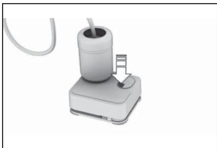
コンプレッサーを最長 10 分間作動させて、シール剤が充填され、タイヤ空気圧が約 2.0 バールに達するようにします。
