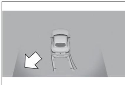
センサーによって車両が検知されると、クリアランスソナーの画面の縁の部分が赤く点滅します。
