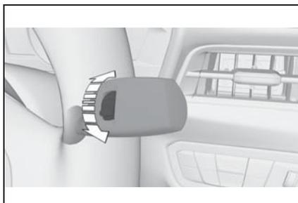
レイン センサーの感度を調節するにはダイヤルを回します。
