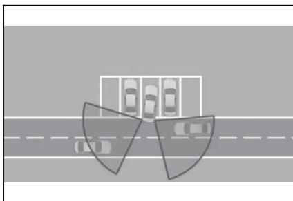
リアバンパー内にある2個のレーダーセンサーが車両後方の空間をモニターします。
