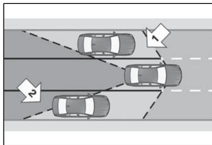
最低速度以上になると、レーダーセンサーが車両の後方および横の空間をモニターします。
