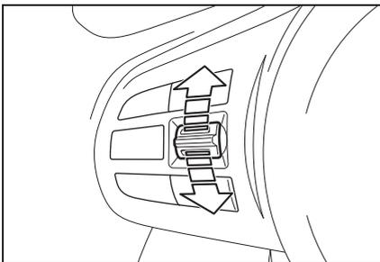
中断した状態でタンブラースイッチを上または下に1回押します。システムがオンになります。
