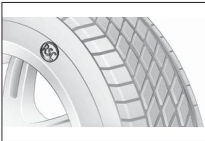
タイヤ側面部分に RSC-Runflat System Component と刻印されています。
