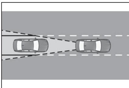
レーダー センサーは車両後方の空間をモニターします。
