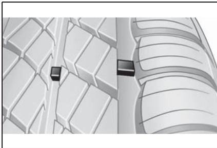
タイヤトレッドの摩耗レベルを示すために、タイヤのトレッド面全体にタイヤメーカーにより少なくとも約1.6mmの摩耗インジケーターが施されています。
