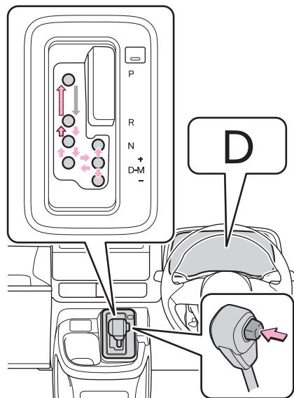
←：エンジンスイッチが ON の状態で、ブレーキペダルを踏んだ状態でシフトレバーのボタンを押しながら操作します。※
