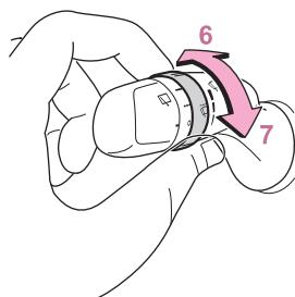
間欠作動を選択しているとき、間欠時間を調整することができます。
