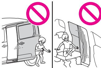
ライドドアの誤操作防止のため、パワースライドドアの機能を停止してください。
