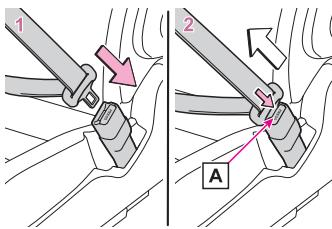
2 ベルトを固定するには、プレートA、プレートBの順に“カチッ”と音がするまでプレートをバックルに挿し込む
