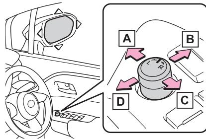
2 ミラーの鏡面を調整するにはスイッチを操作する
