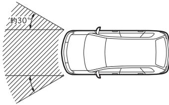
デュアルSRSエアバッグは、車両前方左右約30°以内の方向から乗員に重大な傷害がおよぶような強い衝撃を受けたときに作動します。
