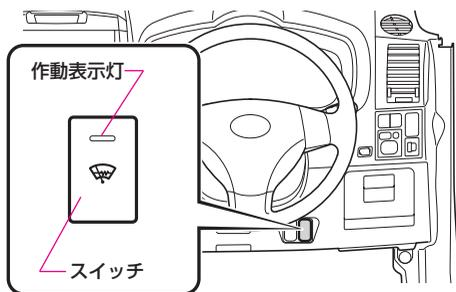
スイッチを押すと約15分間作動し、作動中にもう一度押すと停止します。
