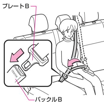
**3** プレートBを“カチッ”と音がするまでバックルBに差し込みます。
