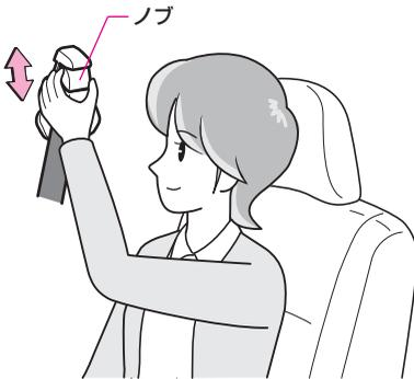
ノブを持ってベルトの高さを調整します。
