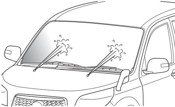
エンジンを始動し、ウインドウウォッシャーを作動させ、噴射の向き、および高さがワイパーの作動範囲のほぼ中央に当たるかを点検します。
