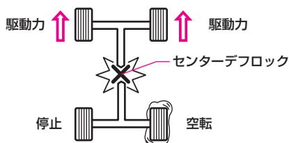
前輪と後輪の駆動力がそれぞれ独立し、前輪が空転している場合は後輪、後輪が空転している場合は前輪が動くようになります。
