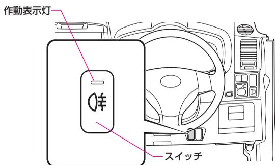
スイッチを押すと点灯し、点灯中にもう一度押すと消灯します。
