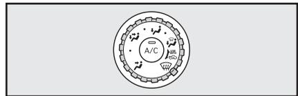
吹き出し口切り替えダイヤルで吹き出し口を選択します。(次ページ参照)
