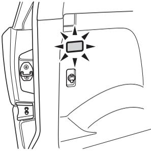
バックドアの開閉と連動して点灯・消灯します。
