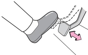
エンジンを始動し、ブレーキペダルをいっぱいに踏み込み、床板とのすき間（P.422参照）を点検します。併せてペダルの感触に異常がないかを点検します。
