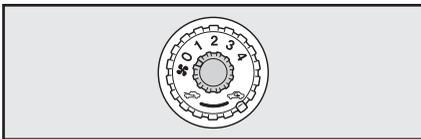
ファン調整ダイヤルで風量を設定します。風量は4段階に切り替えることができます。
