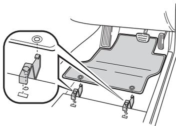
フロアマット付属の固定フック（クリップ）を使用して固定してください。固定フック（クリップ）の形状およびフロアマットの固定方法はイラストと異なる場合があります。詳しい固定方法はフロアマット付属の取扱書をお読みください。
