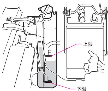
冷却水の量がリザーバートankの上限と下限の間にあるかを点検します。
