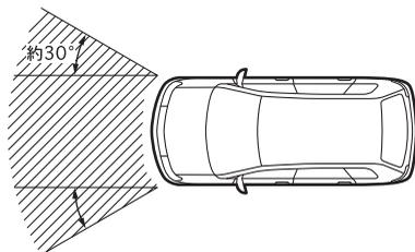
車両前方にグリルガードなどを装着すると、センサーが正常に衝撃を感知できなくなり、デュアルSRSエアバッグの正常な作動を損なうおそれがあります。
