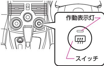
スイッチを押すと作動し、作動中にもう一度押すと停止します。
