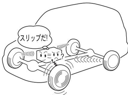
タイヤのスリップは4輪に取りつけられたセンサーからの信号を比較し、駆動輪のいずれかの信号がほかの車輪より多い場合、スリップしているとコンピューターが判断します。
