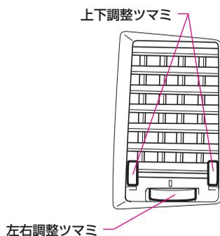
吹き出し口のツマミを動かしてお好みの風向きに調整します。
