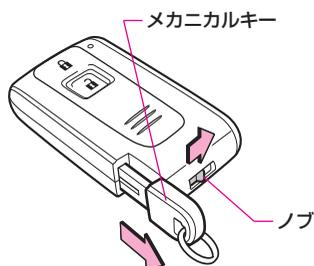
電子カードキーのノブを矢印の方向にスライドさせたまま、メカニカルキーを引き抜きます。
