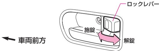
ロックレバーを車両前方に押し込むと施錠、後方に引き出すと解錠されます。
