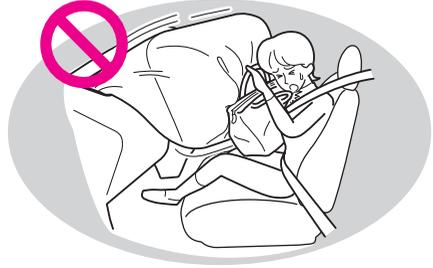
■ドアにもたれかかったり、フロント・センター・リアピラーやルーフサイド部に近づかないようにしてください。(SRSサイドエアバッグ&SRSカーテンシールドエアバッグ装着車)
