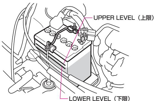
バッテリー液面が各液槽ともバッテリーのUPPER LEVEL（上限）と LOWER LEVEL（下限）の間にあるかを車両をゆするなどして点検します。
