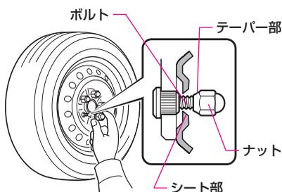
ナットのテーパ部が、ディスクホイール穴のシート部に軽く当たるまで仮締めします。
