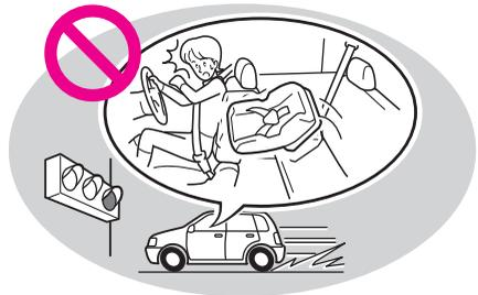
● 車両に子供専用シートを搭載するときは、適切な方法で確実にシートに取りつけてください。子供専用シートを使用しない場合でも、シートにしっかり固定されていない状態で、客室内に置くことは避けてください。
