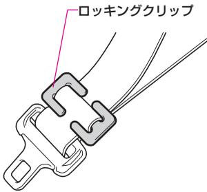
チャイルドシートにシートベルトの固定装置が備わっていない場合は、ロックングクリップ（別売）を使用して固定します。
