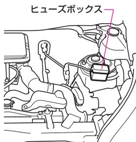
カバー横のツメを押しながらカバーを持ち上げ、カバーをはずします。
