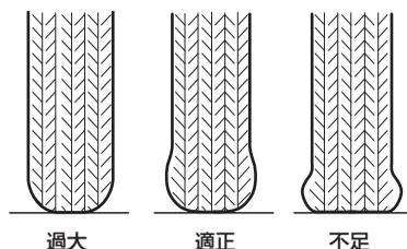
タイヤが冷えている（走行前）状態でタイヤの接地部のたわみ状態（つぶれ具合）を見て、空気圧が適正であるかを点検します。
