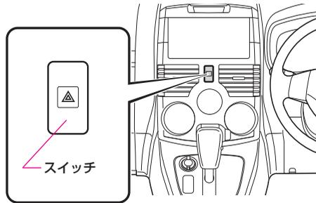
スイッチを押すとすべての方向指示灯が点滅し、点滅中にもう一度押すと消灯します。
