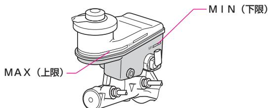
ブレーキフルードの量がリザーバータンクのMAX (上限) とMIN (下限) の間にあるかを点検します。
