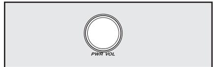
音量調整ツマミで調整します。音量を大きくするときは右側、小さくするときは左側にツマミをまわします。
