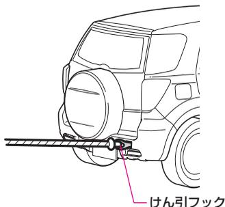
リアのけん引フック取り付け穴は、リアバンパーの運転席側にあります。けん引フックの取り付け方は、P.458の「けん引してもらうときは」を参照してください。
