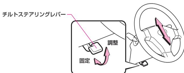
チルトステアリングレバーを引き上げ、ハンドルを上下に動かし適切な位置にして、レバーをいっぱいまで押し下げると固定されます。
