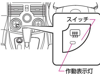
スイッチを押すと約15分間作動し、作動中にもう一度押すと停止します。
