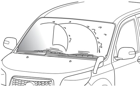
エンジンを始動し、ウインドウウォッシャーでガラスをぬらした状態でワイパーを作動させ、「間欠作動」「低速作動」「高速作動」「一時作動」の各作動が良いか、拭き取り状態が良いかを点検します。
