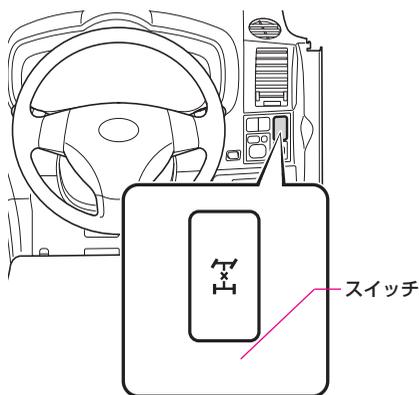
スイッチを押すとセンターデフがロックされ、ロックされているときにもう一度押すと解除されます。
