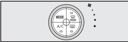
ファン調整ダイヤルで風量を設定します。風量は7段階に切り替えることができます。
