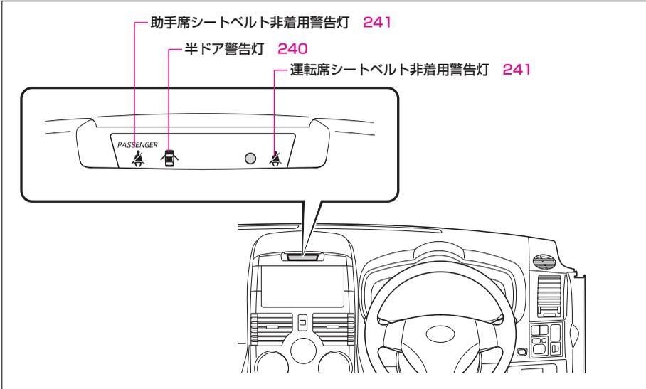
図ではすべてのグレードにおける警告灯を掲載しています。実際の車に設定される警告灯はグレード等により異なります。
