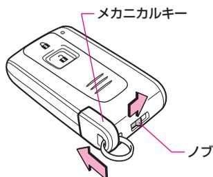
電子カードキーのノブを矢印の方向にスライドさせたまま、メカニカルキーを差し込み、ノブをもどしてロックします。
