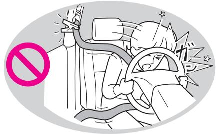
■リヤシート左右席のシートベルトを使用するときは、ベルトハンガーにシートベルトがかかっていることを確認してください。
