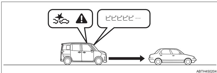
前方車両<sup>※</sup>・歩行者に対し、衝突の危険性が非常に高いと判断したときに、1次ブレーキより強くブレーキ制御を行います。
