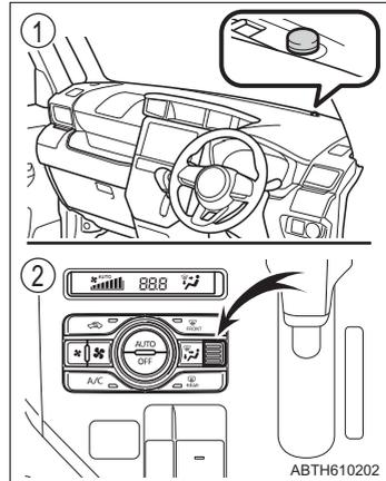
日射センサーの上にものを置いたり、内気センサーをシールなどでふさぐなどすると、センサーが正常に作動しなくなることがあります。
