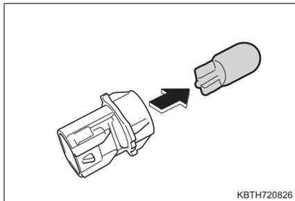
**5** 新しい電球を取り付け、ソケットをまわしてレンズに取り付ける
