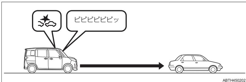
前方車両<sup>※</sup>・歩行者に対し、衝突の危険性があると判断したときに、ブザーとディスプレイの表示（→P. 254）で運転者に注意喚起して衝突回避操作を促します。
