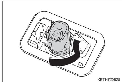
**4** 電球を取りはずす
