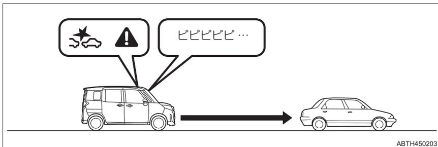
前方車両<sup>※</sup>・歩行者を認識して、衝突の可能性が高いと判断したときに、ブザーを変化させブレーキ制御を行います。
