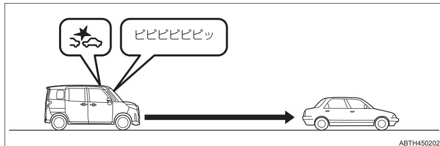
前方車両※・歩行者に対し、衝突の危険性があると判断したときに、ブザーとディスプレイの表示（→ P. 256）で運転者に注意喚起して衝突回避操作を促します。
