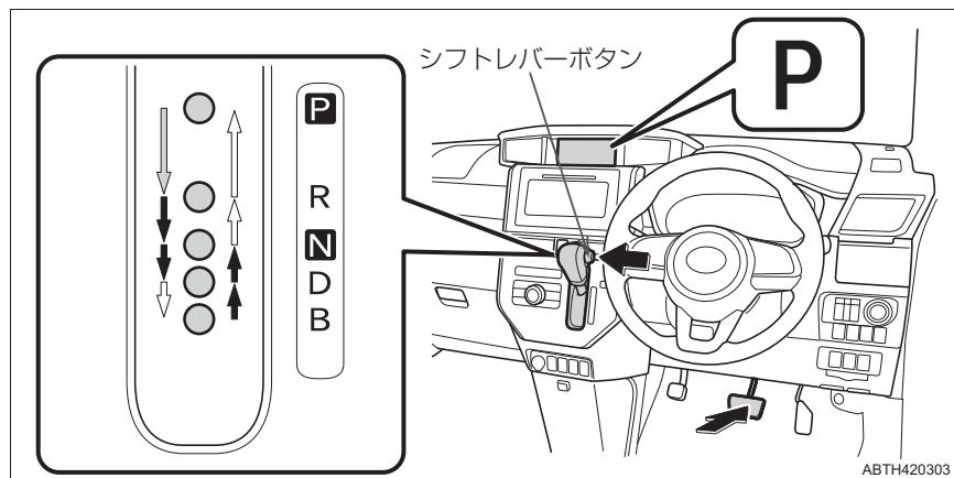
➡ エンジンスイッチが“ON”の状態で、ブレーキペダルを踏んだままシフトレバーボタンを押して操作します。
