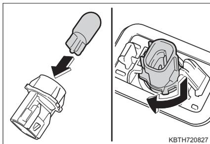
**6** コネクターを挿し込み、ランプ本体を取り付ける
