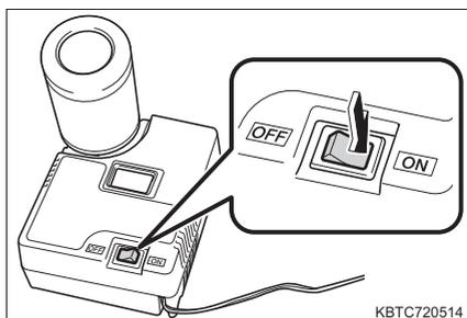
**16** 空気圧ゲージで確認しながら、指定空気圧になるまで昇圧する
