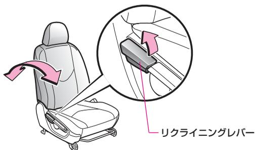
レバーを引いたまま、背もたれを前後に動かして調整します。調整後、シートを軽くゆさぶり確実に固定されていることを確認します。
