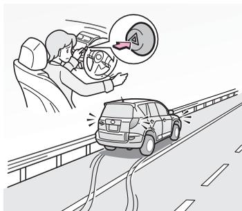
非常点滅灯（P.279の「非常点滅灯スイッチの使い方」参照）を点滅させながら、車を路肩に寄せ停車します。
