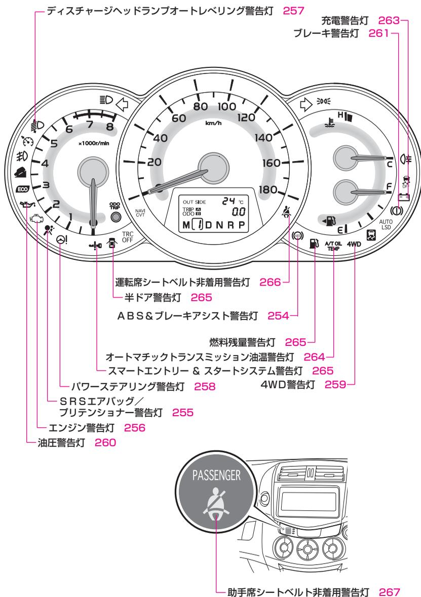
図ではすべてのグレードにおける警告灯を掲載しています。実際の車に設定される警告灯はグレード等により異なります。
