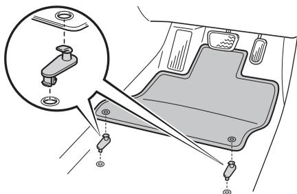
フロアマット付属の固定フック（クリップ）を使用して固定してください。固定フック（クリップ）の形状およびフロアマットの固定方法はイラストと異なる場合があります。詳しい固定方法はフロアマット付属の取扱書をお読みください。
