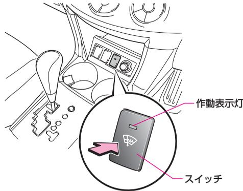
スイッチを押すと約15分間作動し、作動中にもう一度押すと停止します。
