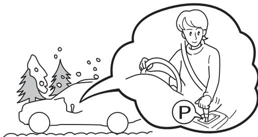
下り坂では前輪の前側、上り坂では後輪のうしろ側に輪止めをして、パーキングブレーキをかけず、シフトレバーをPにします。
