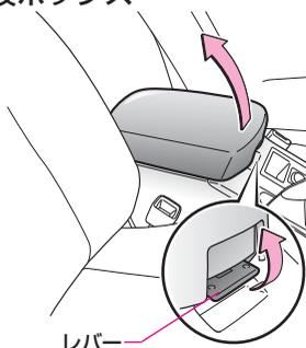
下段ボックスを使用するときは、レバーを引きながらフタを開けて使用します。
