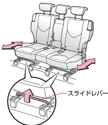
レバーを引いたまま、シートを前後に動かして調整します。調整後、シートを軽くゆさぶり確実に固定されていることを確認します。
