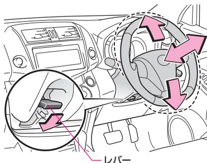
レバーを押し下げ、ハンドルを上下、前後に動かし適切な位置にして、レバーを引き上げると固定されます。
