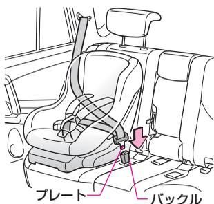
チャイルドシートにシートベルトを取りつけ、プレートをバックルに“カチッ”と音がするまで差し込みます。
