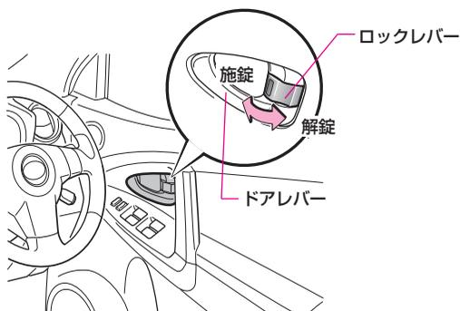
ロックレバーを前方に押し込むと施錠、後方に引き出すと解錠されます。
