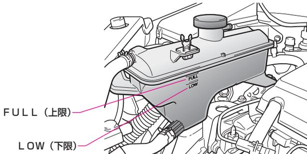
エンジンが十分に冷えてから点検します。
