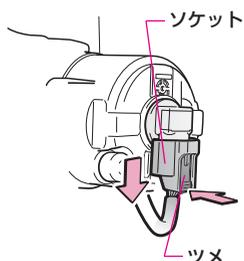
**2** ツメを押して電球からソケットを取りはずします。
