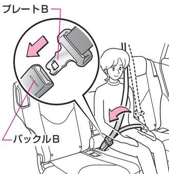
**4** プレートBを“カチッ”と音がするまでバックルBに差し込みます。
