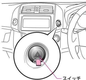
スイッチを押すとすべての方向指示灯が点滅し、点滅中にもう一度押すと消灯します。
