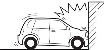
● 衝突時に変形・移動しないコンクリートのような固い壁に正面衝突したときであっても、衝突速度が約25km/h以下のときは作動しない場合があります。
