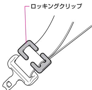
チャイルドシートにシートベルトの固定装置が備わっていない場合は、ロッキングクリップ（別売）を使用して固定します。
