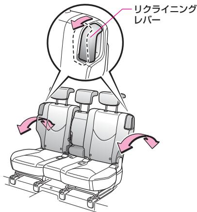
レバーを引いたまま、背もたれを前後に動かして調整します。調整後、シートを軽くゆさぶり確実に固定されていることを確認します。
