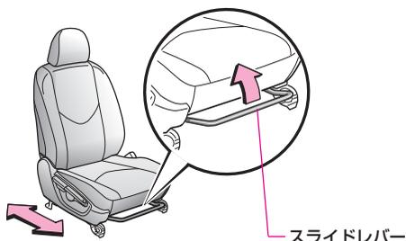
レバーを引いたまま、シートを前後に動かして調整します。調整後、シートを軽くゆさぶり確実に固定されていることを確認します。
