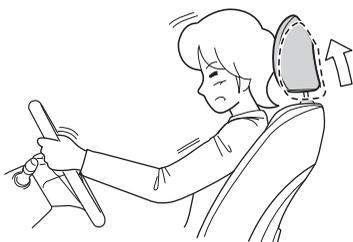
背もたれに強い衝撃を受けると、フロント席乗員のむち打ちの症状を軽減させるためにヘッドレストが少し前方上側に動きます。
