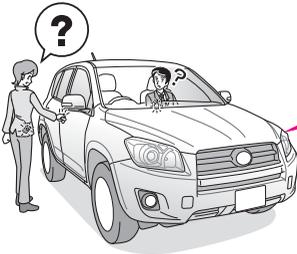
スマートエントリー & スタートシステムでの施錠できません。車外から施錠するときは、ワイヤレスドアロックリモコン (P.161参照) またはメカニカルキー (P.150参照) を使って施錠してください。
