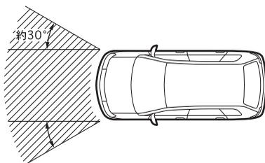
車両前方にグリルガードなどを装着すると、センサーが正常に衝撃を感知できなくなり、SRSエアバッグの正常な作動を損なうおそれがあります。
