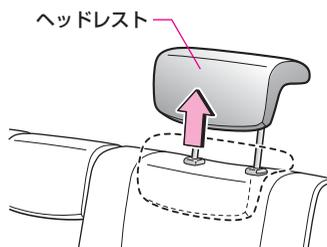
**3** リヤシートのヘッドレスト“カチッ”と音がするところまで引き上げます。ヘッドレストが固定されていることを確認してください。
