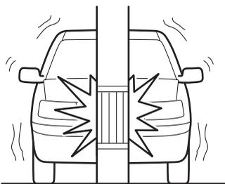
● 衝突時に変形・移動しない電柱や立木などの狭い範囲に正面衝突したときであっても、衝突速度が約30km/h以下の場合には作動しない場合があります。
