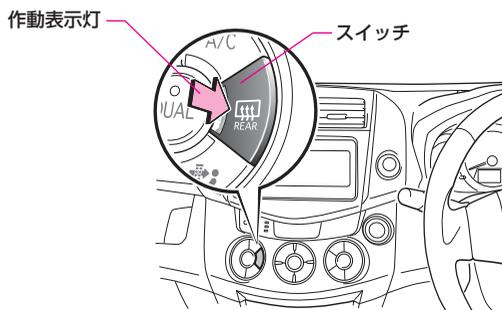
スイッチを押すと約15分間作動し、作動中にもう一度押すと停止します。
