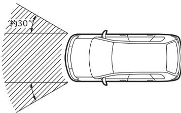
運転席・助手席SRSエアバッグは、車両前方左右約30°以内の方向から乗員に重大な傷害がおよぶような強い衝撃を受けたときに作動します。
