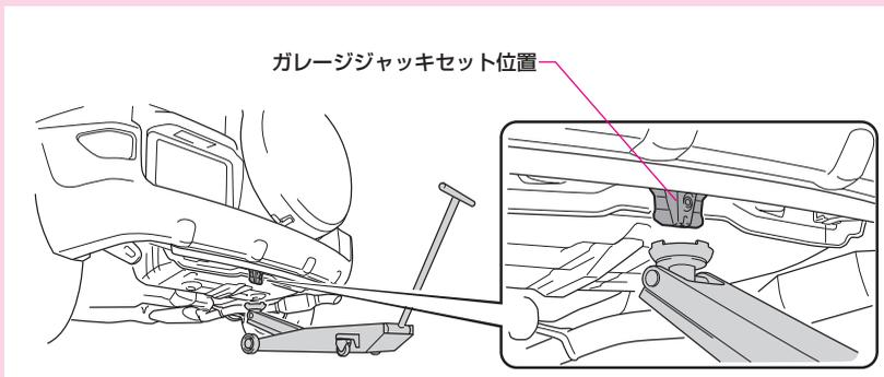
ガレージジャッキは、受皿の形状がガレージジャッキセット位置に適したサイズを受皿タイプを使用してください。
