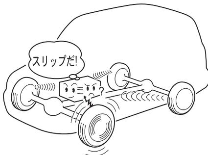
タイヤのスリップは4輪に取りつけられたセンサーからの信号を比較し、いずれかの信号のみほかの車輪より多い場合、スリップしているとコンピューターが判断します。それによって、スリップしているタイヤの駆動力を抑えようとブレーキをかけたり、エンジンの出力を一時的に抑えたりして、スリップを抑制させます。
