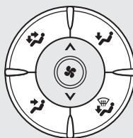
吹き出し口切り替えスイッチで吹き出し口を選択します。(次ページ参照)
