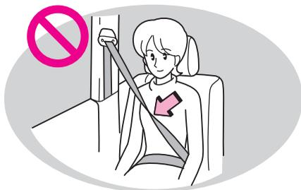
正しい運転姿勢でもシートベルトがねじれていたり、ゆるんでいたり、確実にロックをしていない場合には、衝突したときなどに、シートベルトが十分な効果を発揮せず重大な傷害におよぶか、最悪の場合死亡につながるおそれがあります。
