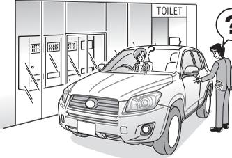
スマートエントリー & スタートシステムでの解錠ができないときは、ワイヤレスドアロックリモコン (P.161参照) またはメカニカルキー (P.150参照) を使って解錠してください。
