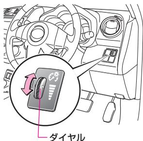
メーター照度調整ダイヤルにより、メーター照明の明るさを調整できます。
