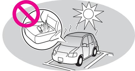
● 車内が大変高温になるため、ライターやスプレー缶のガスが自然にもれたり、破裂したりして、車両火災につながるおそれがあり危険です。
