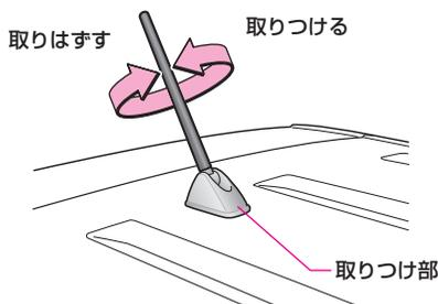
取りはずすときは、アンテナをまわして取り付け部から取りはずします。
