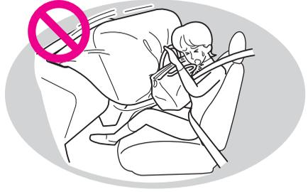
■ドアにもたれかかったり、フロント・センター・リアピラーやルーフサイド部に近づかないようにしてください。(SRSサイドエアバッグ&SRSカーテンシールドエアバッグ装着車)
