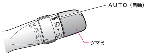
ツマミをAUTOにまわすと周囲の明るさに応じて、ヘッドランプ・車幅灯などが自動で点灯・消灯します。
