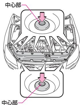
3 運転席側ではクリップをはずし、ウォッシャー液注入口の位置を移動します。クリップの中心部を押し込んでロックをはずし、引き抜きます。
