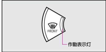
フロントデフロスタースイッチを押し、内外気切り替えスイッチを外気導入にします。
