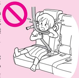
道路運送車両の保安基準に適合する I S O F I X 対応チャイルドシート固定専用バー&トップテザーアンカー対応のトヨタ純正子供専用シートは、I S O F I X 対応チャイルドシート固定専用バー&トップテザーアンカーで固定し、この車のシートベルトでは固定しないでください。
