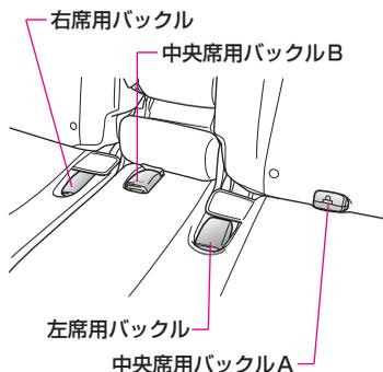
1 リヤ中央席のシートベルトを分離 (P.196参照) し、バックルを格納します。
