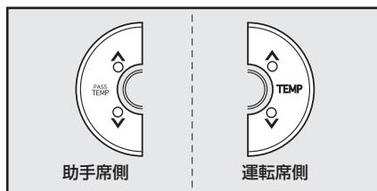
独立モードのときに運転席は運転席側スイッチ、助手席は助手席側スイッチを押して、希望する室内温度に設定することができます。
