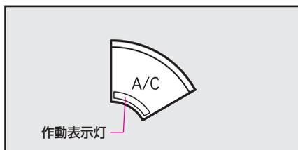
ファンが作動中のとき、エアコンスイッチを押すごとに、エアコン（冷房、除湿機能）がONとOFFに切り替わります。
