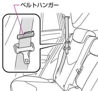
**2** リヤ左右席のシートベルトをベルトハンガーに挟みます。
