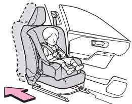
● チャイルドシートに座らせてている場合でも、ドア・シート・フロントピラー・リヤピラー・ルーフサイドレール付近にお子さまの頭や体のどの部分も、もたれかけないようにしてください。SRS エアバッグがふくらんだ場合、大変危険であり、重大な傷害におよぶか、最悪の場合死亡につながるおそれがあります。
