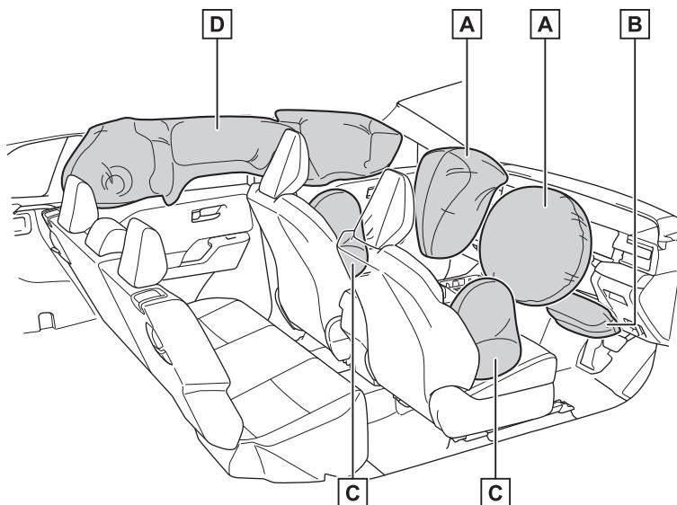
A フロント SRS エアバッグ（運転席 SRS エアバッグ／助手席 SRS エアバッグ）
