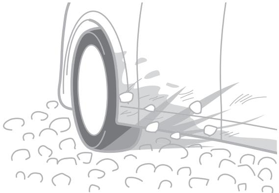
段差や凸凹のある荒れた路面を走行すると、タイヤの空気が抜けることがあります。タイヤの空気が抜けると、タイヤのクッション性能が低下し、車両に損傷を与えるおそれがあります。
