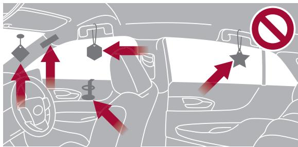
SRS エアバッグが展開する次のような部位に何かを付けたり、置いたり、かけたりしないでください。SRS エアバッグが正常に作動するのをさまたげ、システムが作動しない、または誤って作動するおそれがあります。
