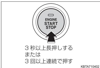
ハイブリッド車：パワースイッチを2秒以上長押しするか、素早く3回以上連続で押してハイブリッドシステムを停止する
