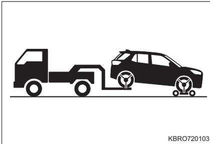
台車を使用して前輪を持ち上げる
