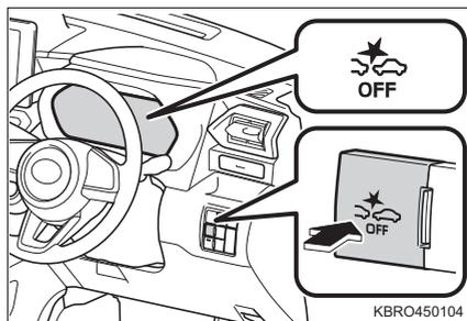
■ 車線逸脱警報機能・車線逸脱抑制制御機能・路側逸脱警報機能・ふらつき警報・LKC★を停止するとき
