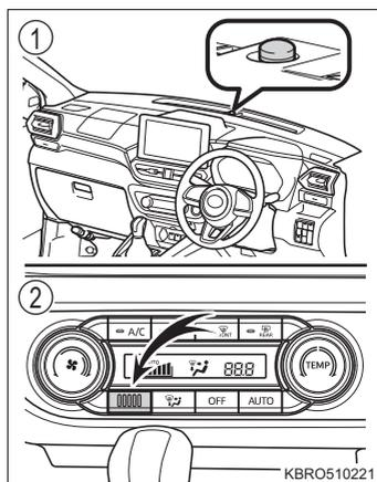
日射センサーの上にものを置いたり、内気センサーをシールなどでふさぐなどすると、センサーが正常に作動なくなることがあります。
