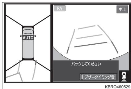
9 ガイダンスに従って、停止位置（目標駐車枠内）で停止する
