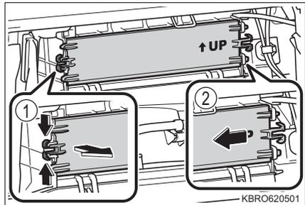
4 フィルターを取り外し、新しいフィルターと交換する
