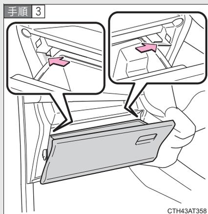
インストルメントパネルの図に示す部分を外側に押し、グローブボックス上部のツメを片側ずつはずす
