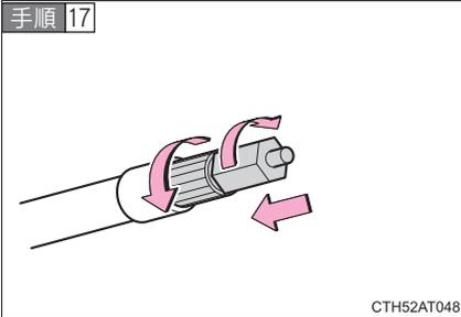
ボトルのホース先端に空気逃がしキャップを取り付ける
