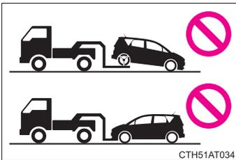
必ず前輪を持ち上げるか、4輪とも持ちあげた状態で運搬してください。前輪が地面に着いた状態でけん引すると、駆動系部品が破損するおそれがあります。
