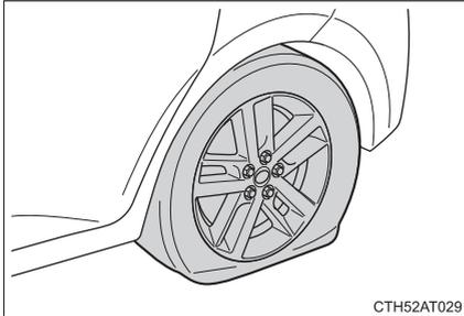
応急修理をする前に、タイヤ損傷の程度を確認する
