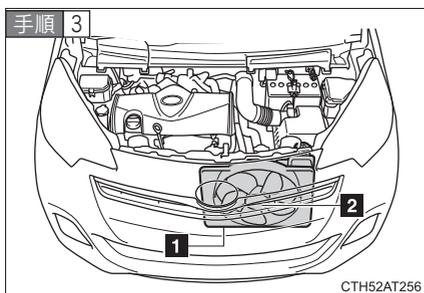
エンジンが十分に冷えてから、ラジエーターコア部（放熱部）やホースなどからの冷却水もれを点検する
