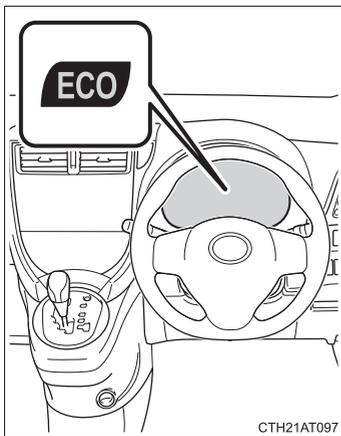
エコドライブインジケータランプが点灯すると、環境に配慮した運転をしていることを知らせます。必要以上にアクセルペダルを踏むと消灯します。
