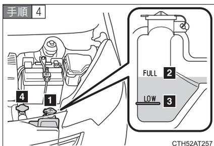
冷却水の量がリザーバータンクの“FULL”（上限）と“LOW”（下限）のあいだにあるかを点検する
