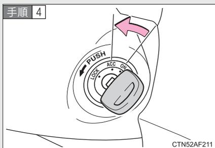
スマートエントリー&スタートシステム非装着車：エンジンスイッチを“ACC”にして、エンジンを停止する。
