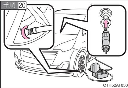
走行後、ボトルのホースから空気逃がしキャップを取りはずし、再度応急修理キットを接続する
