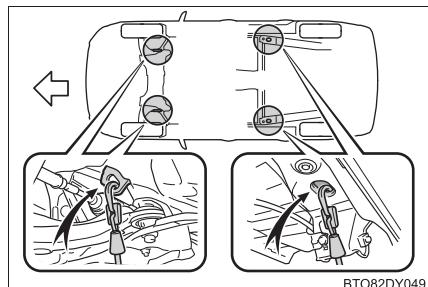
鎖やケーブルなどを使用して車両を固縛する場合は図に黒く示す角度が 45° になるように固縛する
