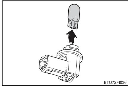
**5** 新しい電球を取り付け、ソケットを取り付ける**6** コネクターを取り付ける**7** 内張りとカバーを取り付け、バックドアを閉める
