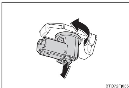
**4** 電球を取りはずす
