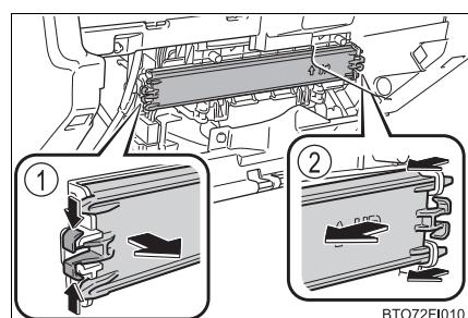
**④ フィルターを取りはずし、新しいフィルターと交換する**
