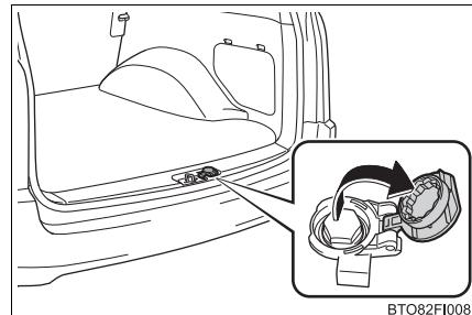
**2** スペアタイヤ格納具がフックからはずせる程度にボルトをゆるめる
