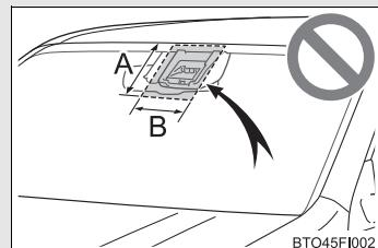
●フロントウインドウガラス内側の前方センサー下部（図に示す範囲内）に何も取り付けたり、貼り付けたりしない
