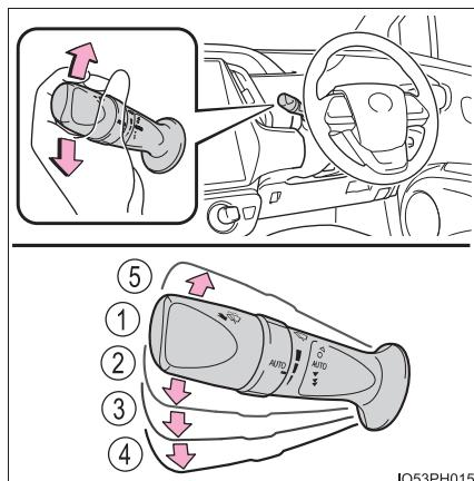
AUTO モード (AUTO) を選択しているとき、次のようにツマミをまわして雨滴センサーの感度を調整できます。
