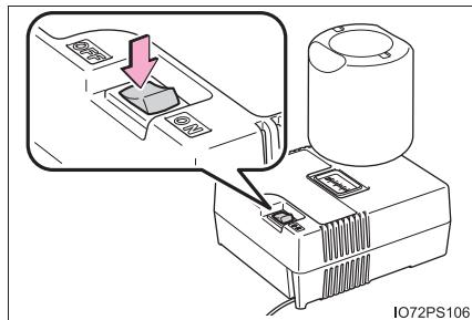
**9 コンプレッサーの電源プラグをアクセサリーソケットに挿し込む (→ P. 572)**
