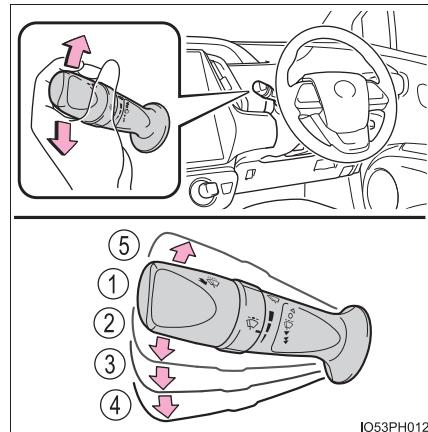
間欠作動
