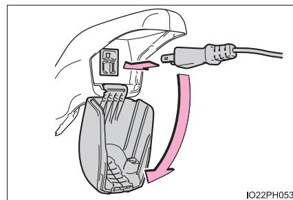
**9 防水ゴムに電源コードを通し、防水カバーを閉じる**
