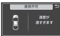
使用不可<br>速度が<br>速すぎます                                        | ハイブリッドシステムが作動していない<br>→ハイブリッドシステムを始動してください。<br>センサー部に氷・雪・泥などが付着している<br>→氷・雪・泥などを取り除いてください。<br>センサー部が凍結している<br>→凍結部が溶ければ正常に復帰します。<br>補機バッテリーを脱着した<br>→約35km/h以上の車速で5秒以上直進走行してください。 |
