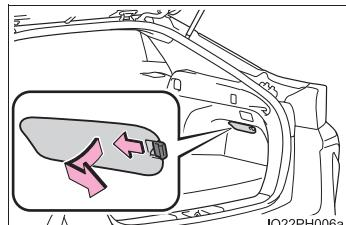
**[3]** 車両下側からななめ上方向に向けて手を入れ、コネクターロック緊急解除レバーに指をかける
