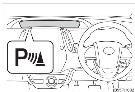
OFF (非作動) に切りかえて、クリアランスソナーを停止させた場合、再度、マルチインフォメーションディスプレイの 画面から ON (作動) に切りかえないシステムは復帰しません。（パワースイッチの操作では復帰しません）
