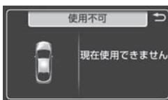
使用不可<br>現在使用できません                                             | システムに故障のおそれがある<br>パワーステアリング装置の一時的な過熱が起きた<br>→パワースイッチをいったんOFFにし、しばらくしてからハイブリッドシステムを始動して使用してください。                                                                                   |
