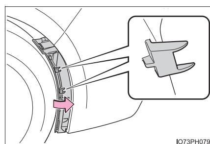
**[9] カバーの上部にクリップ（3個）を取り付ける**
