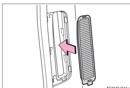
**5** グリルの端のツメを取り付け位置に挿し込み、反対側の端を押し込んでグリルを固定する
