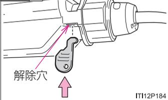
解除キーをコントロールユニットの解除穴に挿し込む
