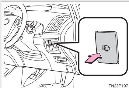
スイッチを押してヘッドランプを洗浄する
