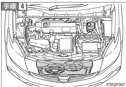
ハイブリッドシステムが十分に冷えてから、冷却水の量や冷却水もれを点検する
