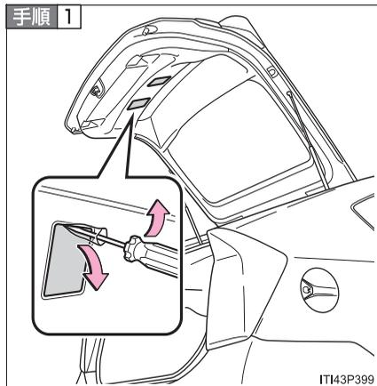
バックドアを開けて、図の位置にある切り欠きにマイナスドライバーを挿し込んで、カバーをはずす
