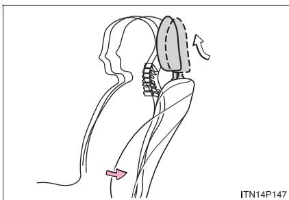
追突の衝撃によって、乗員の腰がシートバックを押し出すことでヘッドレストが少し斜め上方に動き、乗員のむち打ち傷害軽減に貢献します。
