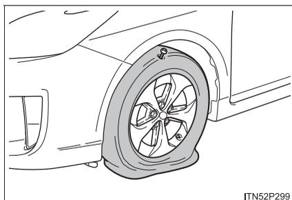
応急修理をする前に、タイヤの損傷程度を確認する
