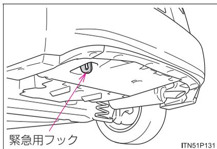
リヤの固縛用フックを緊急用フックとしても使用できます。雪の吹きだまりなどでスタックして走行できなくなったときに緊急的に他車に引っ張り出してもらうときに使用するものです。他車をけん引することはできません。
