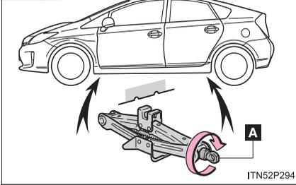
ジャッキの A 部を手でまわして、ジャッキ溝をジャッキセット位置にしっかりかける
