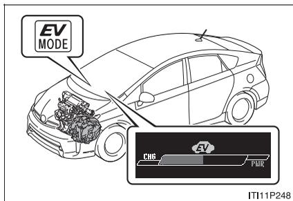
駆動用電池に蓄えられた電気を使用して、電気モーターのみ<sup>\*</sup>で走行します。
