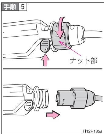
解除キーをコントロールユニットの解除穴に奥まで挿し込んだまま、電源プラグコードのナット部をまわして、電源プラグコードを取りはずす
