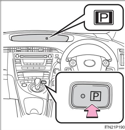
車を完全に停止させ、パーキングブレーキをかけ、P ポジションスイッチを押す
