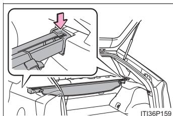
● トノカバーを取り付けるときは、TOPマークを上にして取り付け、確実に固定されたことを確認してください。トノカバーが確実に固定されていないと、走行中にトノカバーがはずれ、思わぬ事故につながるおそれがあり危険です。
