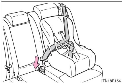
チャイルドシートにシートベルトを取り付け※、プレートを保ックルに“カチッ”と音がするまで挿し込む。ベルトがねじれていないようにする
