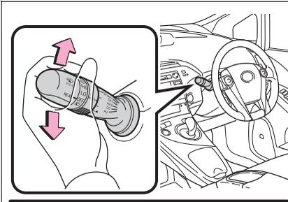
**1** 停止 (OFF)**2** 雨滴感知オート作動 (AUTO)**3** 低速作動 (LO)**4** 高速作動 (HI)**5** 一時作動 (MIST)
