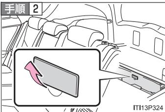
デッキアンダーボックスの側面（バックドア側）にあるカバーを取りはずす
