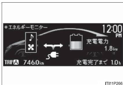
充電電力と電気の流れがエコドライブモニターに表示されます。(→P. 44)
