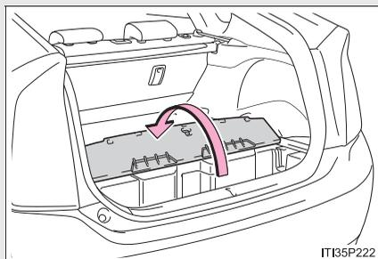
開くときは、ストラップを持ってデッキボードの先端を持ち上げる
