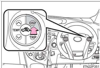
ハンドルにある DISP スイッチを押し、エネルギーモニターを表示させる
