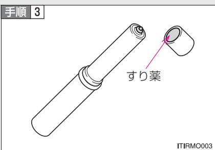
先端のフタを取り、すり薬で発炎筒の先端をこすり、着火させる
