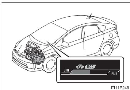
駆動用電池の残量が減少し、電気モーターのみでの走行ができないときは、ガソリンエンジンと電気モーターを併用するハイブリッド車として機能します。
