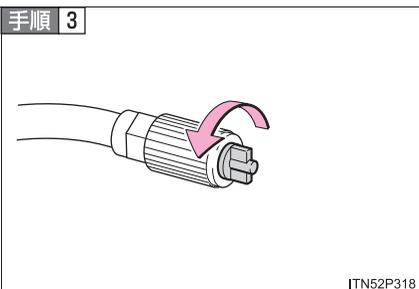
ボトルのホースをのばし、ホースから空気逃がしキャップを取りはずす
