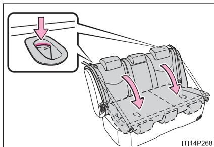
前倒しボタンを押してロックを解除し、背もたれを倒す
