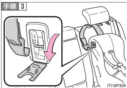
フタを開けて、トップテザーアンカーにフックを固定し、テザーベルトを締める
