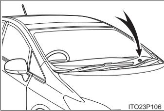
センサーの上にものを置いたり、センサーをふさぐようなものをウインドウガラスに貼らないでください。周囲からの光がさざざされると、自動点灯・消灯機能および、ヘッドアップディスプレイ（装着車のみ）の表示輝度の自動調整機能が正常に働かなくなります。
