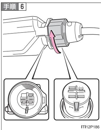
コントロールユニット接合部の突起と、交換用電源プラグコードコネクタの溝を合わせて挿し込み、電源プラグコードのナット部をまわして取り付ける
