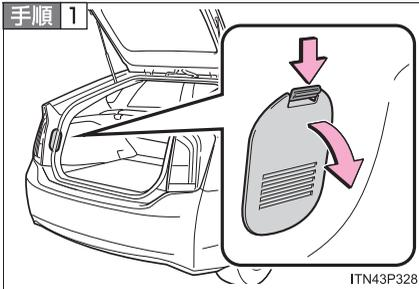
バックドアを開けて、カバーのツメを手前に引いてカバーを取りはずす
