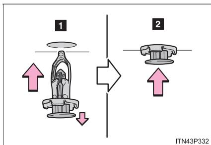
**1** クリップの中央部をいっぱいまで引き出して、取り付け穴に挿し込む
