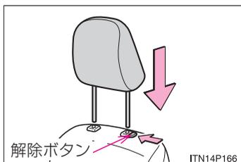
ヘッドレストを取り付け穴に合わせて、ロック位置まで押し下げてください。さらに下げるときは、解除ボタンを押しながら操作してください。
