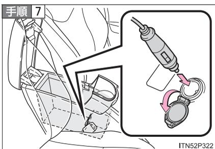
コンプレッサーの電源プラグをアクセサリーソケットに挿し込む (→P. 379)
