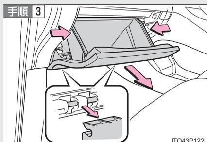
グローブボックスの側面を内側に押し、上部のツメを片側ずつはずし、下部のツメをはずして取りはずす
