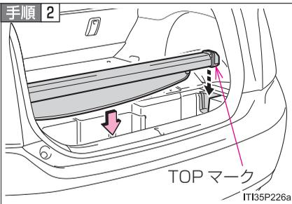
トノカバーの向きを使用時と上下逆さまにし、TOP マークを下にして収納する
