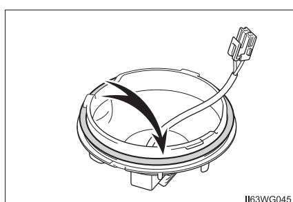
**5** 電球を交換し、コネクターを取り付ける
