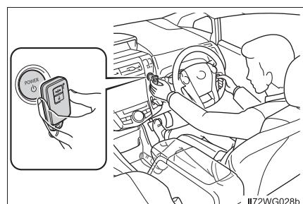
③ ブレーキペダルをしっかりと踏み込んで、マルチインフォメーションディスプレイに が表示されていることを確認する
