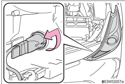
**② 電球を取りはずす**
