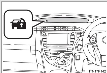
ドア・ボンネットを閉め、スマートエントリー&スタートシステム、ワイヤレスリモコンを使って施錠します。
