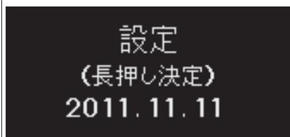
ハンドルの DISP スイッチを押して、エコドライブモニターに「設定」画面を表示させる(→P. 186)
