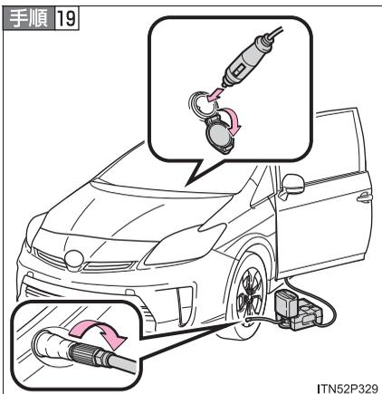
走行後、ボトルのホースから空気逃がしキャップを取りはずし、再度応急修理キットを接続する
