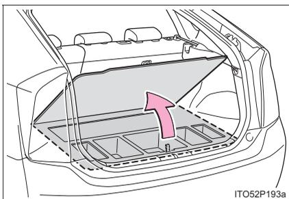
ストラップを引き上げてデッキボードを開き、デッキアンダートレイを持ち上げて、デッキボードごと車両から降ろす
