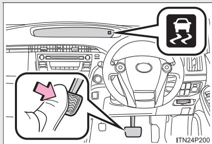
車両が完全に停止している状態で、さらにブレーキペダルを踏み込むとヒルスタートアシストコントロールは作動します。
