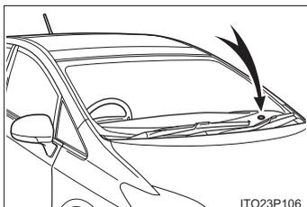
センサーの上にものを置いたり、センサーをふさぐようなものをウインドウガラスに貼らないでください。周囲からの光がさえぎられると、自動点灯・消灯機能および、ヘッドアップディスプレイ（装着車のみ）の表示輝度の自動調整機能が正常に働かなくなります。
