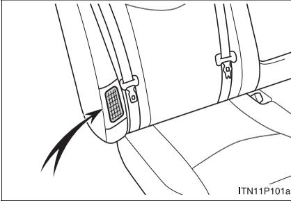
リヤシートの横（運転席側）には、駆動用電池冷却用の吸入口があります。吸入口をふさいだりすると、駆動用電池の過熱や出力低下の原因となります。
