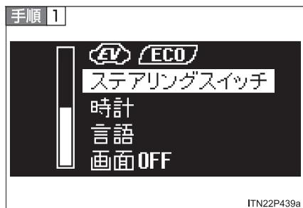
「ステアリングスイッチ」を選択し、DISP スイッチを押し続ける
