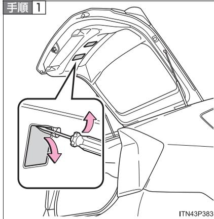
バックドアを開けて、図の位置にある切り欠きにマイナスドライバーを挿し込んで、カバーをはずす
