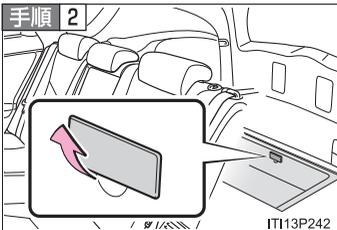
デッキアンダートレイ<sup>\*</sup>の側面(バックドア側)にあるカバーを取りはずす
