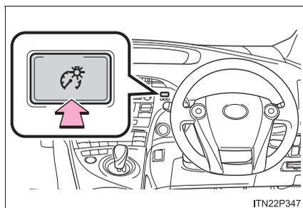
車幅灯が点灯中で、かつ周囲が暗いとき、スイッチを押すたびに、メーター表示の明るさが切りかわります。
