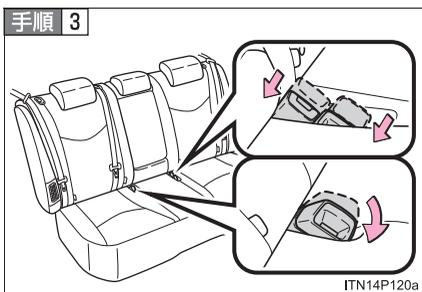
リヤシートベルトのバックルを格納する
