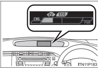
ハイブリッドシステムの作動状況に応じて、インジケーターの表示が変化します。
