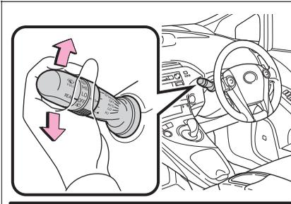
**1** 停止 (OFF)**2** 雨滴感知オート作動 (AUTO)**3** 低速作動 (LO)**4** 高速作動 (HI)**5** 一時作動 (MIST)
