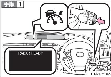
“ON-OFF”スイッチを押して、システムをONにする
