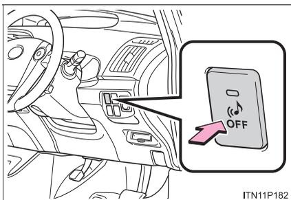
OFF にするには、“パワー”スイッチが ON モードのとき、スイッチを押す
