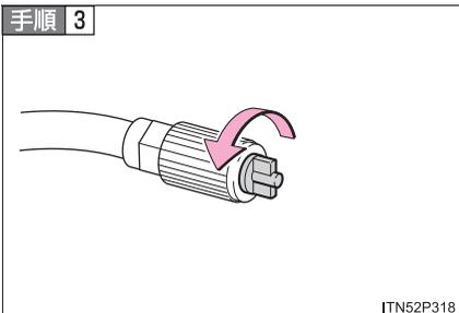
ボトルのホースをのばし、ホースから空気逃がしキャップを取りはずす
