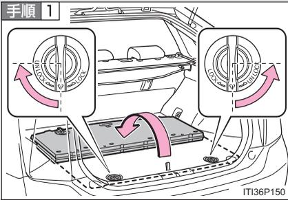
ダイヤルを UNLOCK 側にまわしてデッキボードのロックをはずし、ストラップを持ってデッキボードを折りたたむ
