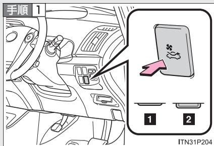
“パワー”スイッチがONモードのときに、換気スイッチを押す
