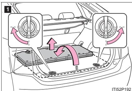
**1** ダイヤルを UNLOCK 側にまわしてロックをはずし、デッキボードを取りはずす
