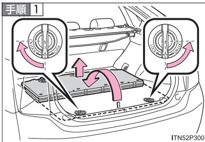
ダイヤルを UNLOCK 側にまわしてロックをはずし、デッキボードを取りはずす
