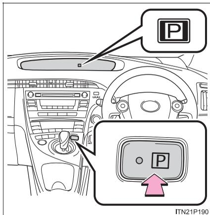
車を完全に停止させ、パーキングブレーキをかけ、P ポジションスイッチを押す
