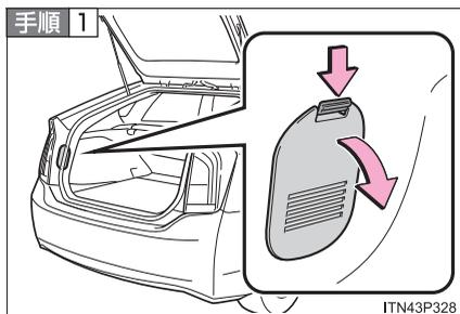
バックドアを開けて、カバーのツメを手前に引いてカバーを取りはずす
