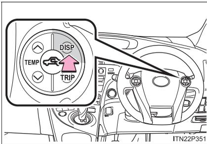
ハンドルにある DISP スイッチを押し、エネルギーモニターを表示させる
