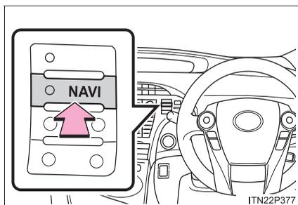
**NAVI** を押して、簡易矢印ナビ／レーン表示の ON・OFF を切りかえる
