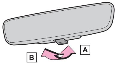
レバーを操作することで、後続車のヘッドライトによる反射光を減少させます。
