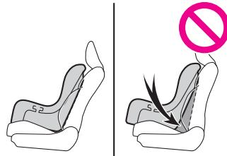
※<sup>3</sup> : ヘッドレストとチャイルドシートが干渉してチャイルドシートが正しく取り付けられない場合、ヘッドレストの取りはずしが可能なときは、ヘッドレストを取りはずしてください。
