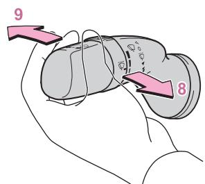
間欠作動を選択しているとき、間欠時間を調整することができます。
