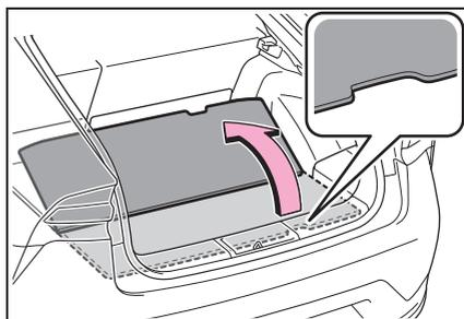
3カ所のクリップを引いてはずし、補機バッテリーカバーを取りはずします。
