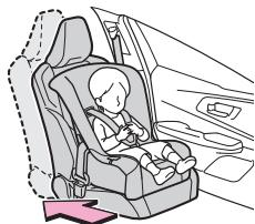
● チャイルドシートに座らせてている場合でも、ドア・シート・フロントピラー・リヤピラー・ルーフサイドレール付近にお子さまの頭や体のどの部分も、もたれかけないようしてください。SRS エアバッグがふくらんだ場合、大変危険であり、重大な傷害におよぶか、最悪の場合死亡につながるおそれがあります。
