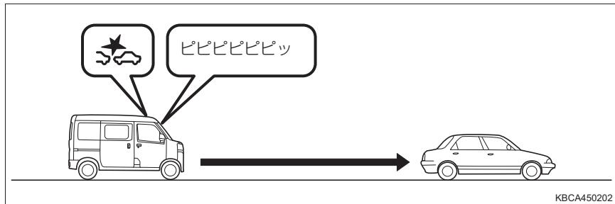
前方車両※・歩行者に対し、衝突の危険性があると判断したときに、ブザーとディスプレイの表示（→ P. 198）で運転者に注意喚起して衝突回避操作を促します。
