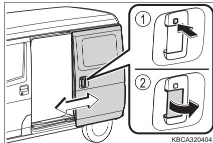
自動開閉作動中にスイッチを押す、またはドアハンドルを引くと自動開閉作動が停止し、再度スイッチを押す、またはドアハンドルを引くと、スライドドアが反対方向に作動します。
