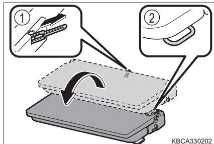
セパレートタイプ：ロック解除ストラップを引きながら（①）、持ち手（ストラップ）を持ち（②）、格納する
