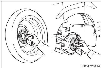
**② 応急用タイヤを取り付け、タイヤががたつかない程度まで手でナットを仮締めする**
