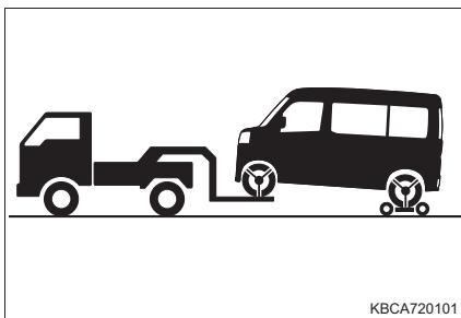
台車を使用して後輪を持ち上げる
