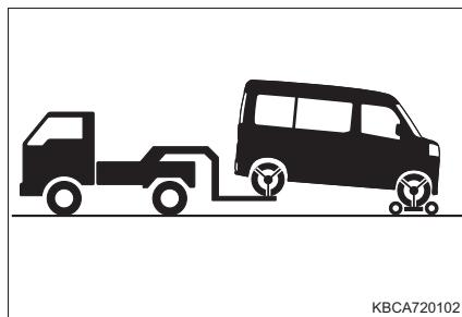
台車を使用して前輪を持ち上げる
