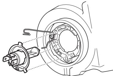
2. クリップを確実にフックに取り付け、バルブを固定します。
