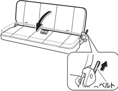
2. バックルを背もたれとシート クッションの間から抜き取り、マットの下に収納します。
