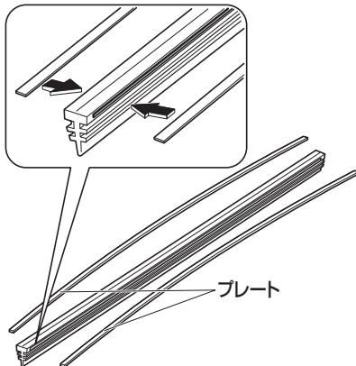
4. ブレードの先端部の 2 番目のツメからラバーを挿入します。
