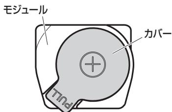
4. 矢印の方向にスライドさせて、電池を取り出し、新しい電池と交換します。
