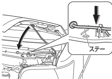
2. ボンネットを静かに下げ、手で押さえるようにして閉めます。
