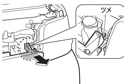
4. ヘッドランプのクリップ(1個)とボルト(2本)を取り外します。
