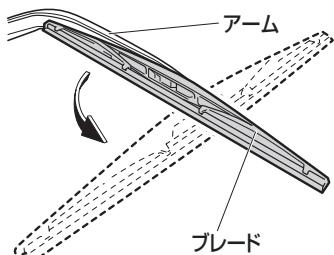
3. ブレードを矢印の方向に引いて、アームからブレードを引き抜きます。
