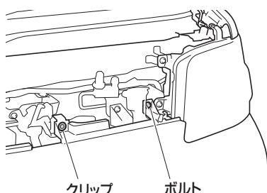
3. バンパーを車両前側に引いてツメを外し、上部を浮かせます。
