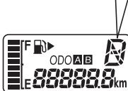
エンジン スイッチが “ON” の位置のとき作動します。使用中のシフト レバーの位置が表示されます。
