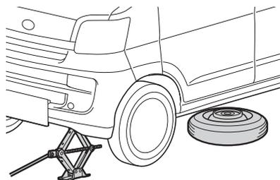
7. 4個のホイールナットを外し、タイヤを外します。
