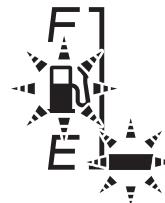
エンジンスイッチが“ON”的とき、燃料残量が約 6l 以下になると、燃料計の一番下の目盛りと燃料残量警告灯が点滅します。
