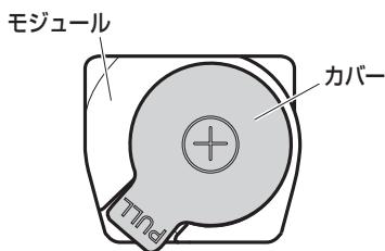
4. 矢印の方向にスライドさせて、電池を取り出し、新しい電池と交換します。
