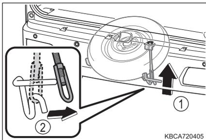
4 格納具を地面におろし、応急用タイヤを両側から持ち、手前に引き出す
