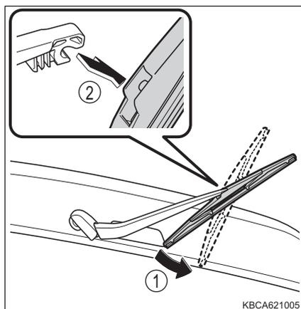
② ワイパーブレードを取り付けるときは ① と逆の手順で取り付ける
