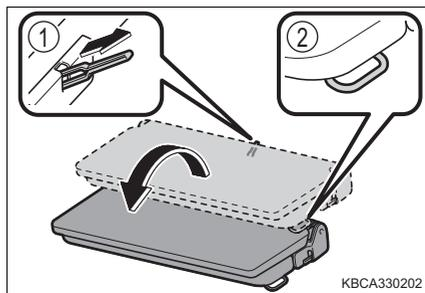
セパレートタイプ：ロック解除ストラップを引きながら (①)、持ち手 (ストラップ) を持ち (②)、格納する
