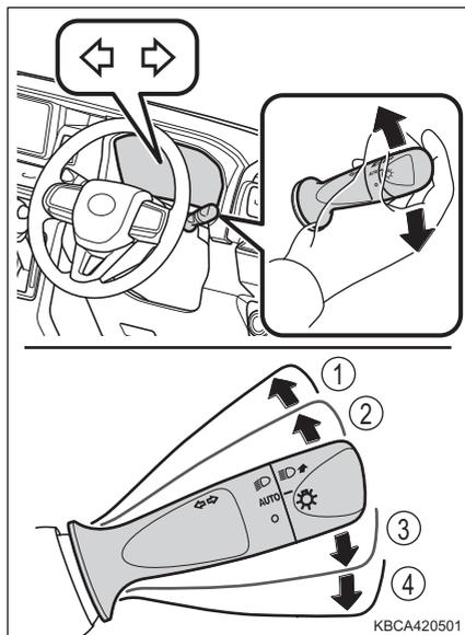
■ 右左折後に方向指示灯の点滅が停止しない場合や、点滅を中止させたいときレバーを逆方向の ② または ③ の位置に操作してください。レバーを ① または ④ の位置まで操作すると、選択した方向指示灯が点滅します。
