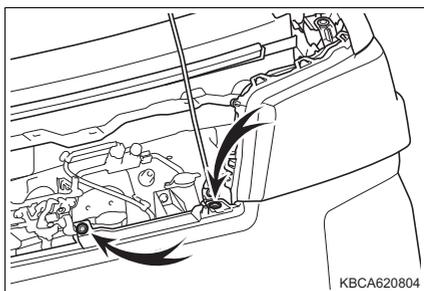
**■ 車幅灯（ハロゲンヘッドランプ装着車）**
