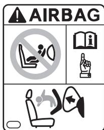
助手席エアバッグの有無にかかわらず、助手席にベビーシートを取り付けたり、チャイルドシートを後ろ向きに取り付けしないでください。
