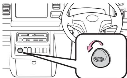
電化製品の電源用ソケットとして利用することができます。
