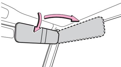
直射日光などでまぶしいときに使用します。側面に移動させて使用することもできます。
