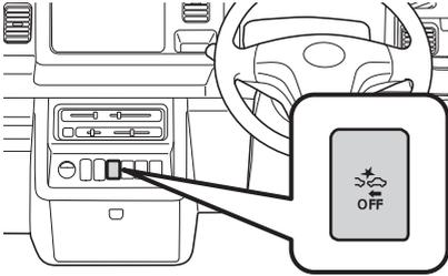
エンジンスイッチが“ON”のとき、スマートアシスト OFF スイッチを操作することで、スマートアシストⅢ tの次の機能を停止することができます。
