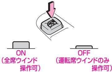
スイッチを押し込むと“OFF”になり、助手席側ドアガラスの開閉ができなくなります。
