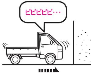
車速が約 4km/h 以下で、アクセルペダルが必要以上に踏み込まれたと判断したときに、ブザーとメーター表示で警報し、運転者に衝突回避操作を促します。
