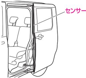
パワースライドドアの自動開閉作動中に、挟み込みを検知したドアを少し反転作動した後、途中で停止させる機構です。
