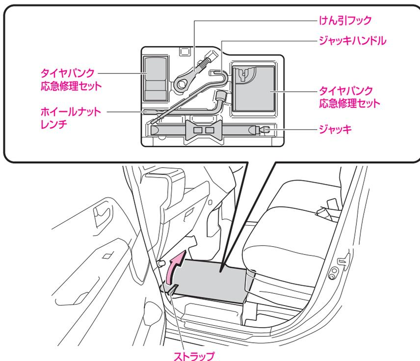
ジャッキ、工具、タイヤパンク応急修理セットは、助手席のフロアボード下にあるアンダーボックスに収納しています。
