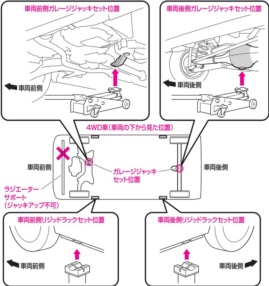
ガレージジャッキを使用する場合は、図のガレージジャッキ位置にセットしてジャッキアップを行ってください。その際は、必ずリジッドラック（市販品）をリジッドラックセット位置にセットしてください。
