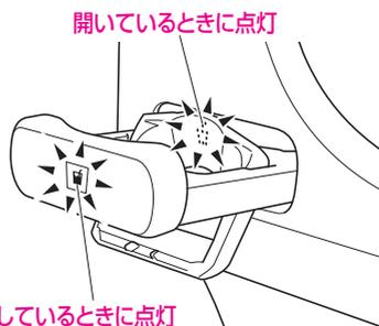
車幅灯が点灯しているときに、シンボル照明が点灯します。
