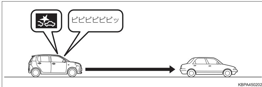
前方車両・歩行者に対し、衝突の危険性があると判断したときに、ブザーとメーター内の表示で運転者に注意喚起して衝突回避操作をうながします。
