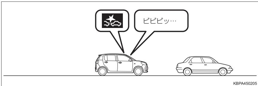
停止後にブザーが鳴り、ブレーキ制御を最長約 1.5 秒間継続した後、ブレーキ制御を解除します。
