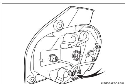
**7** 車両側とランプ本体のクリップの位置を合わせ、ランプ本体を車両前方へ押す
