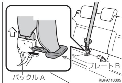
**3 プレート B、プレート A の順に天井のホルダーに格納する**
