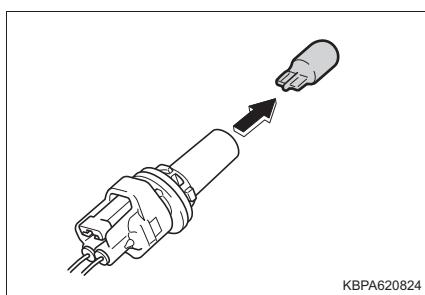
**3 新しい電球を取り付け、ソケットをまわして取り付ける**
