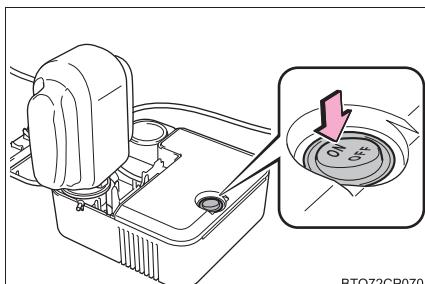
**[14] 空気圧が指定空気圧になるまで充填する**
