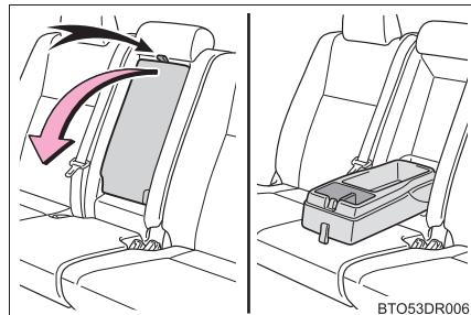
格納式センターBOXを倒して使用する
