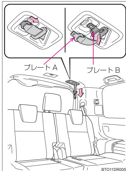
**②** ベルトを固定するには、プレート A、プレート B の順に “カチッ”と音がするまでプレートをバックルに挿し込む
