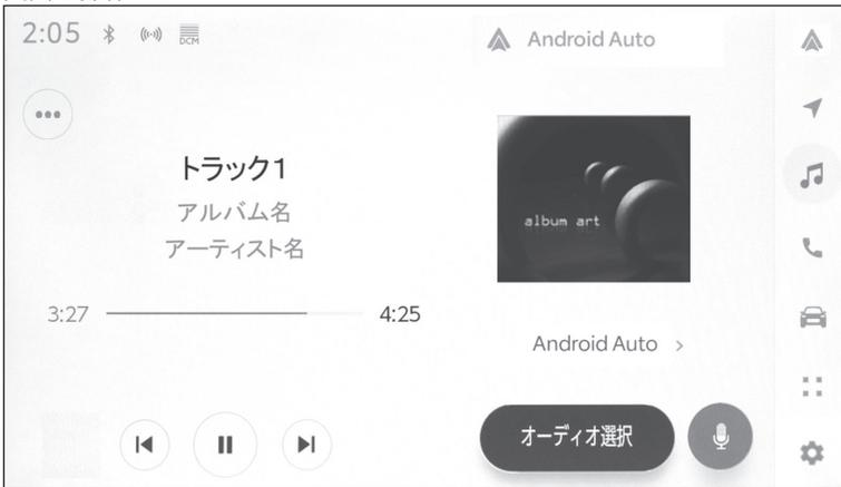
[⏮]: 再生中のトラックの先頭から再生します。トラックの先頭のときは、前のトラックの先頭から再生します。
