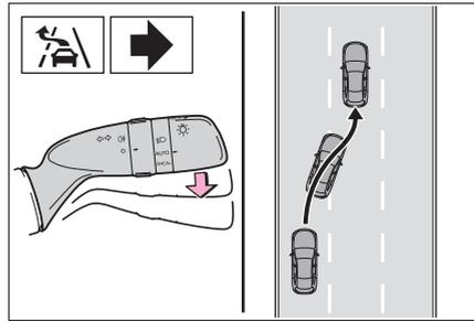
● ディスプレイ表示で車線変更を提案しているときに方向指示レバーを途中で保持すると、車線変更支援を行います。
