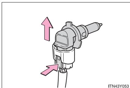
3 電球を交換し、ソケットを取り付ける
