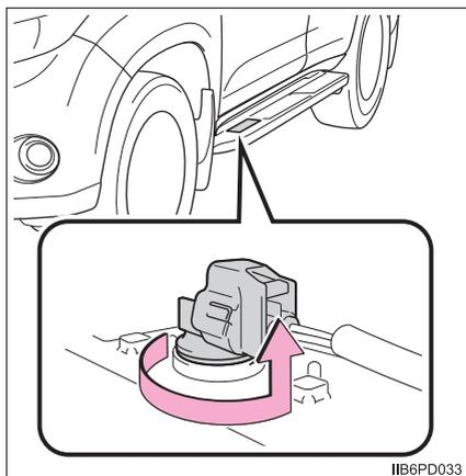
**2** 電球を取りはずす
