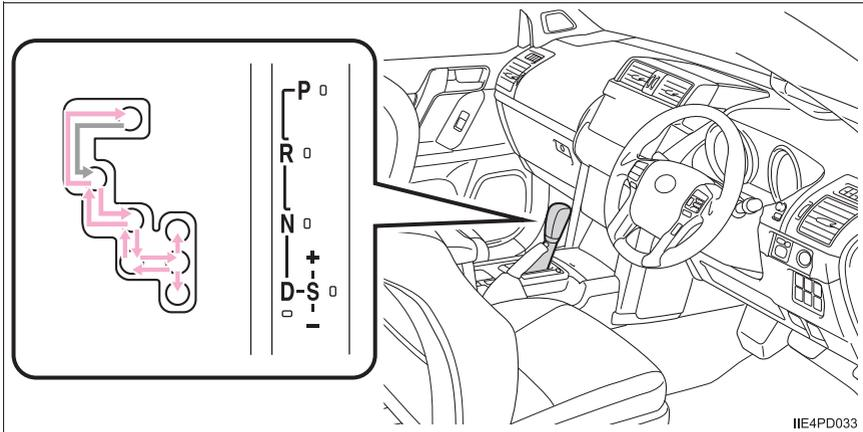
← エンジンスイッチがイグニッション ON モードの状態では、ブレーキペダルを踏んだまま操作します。
