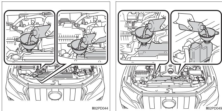
**6 エンジンを始動し、エアコンを作動させてラジエーター冷却用のファンが作動しているか、およびラジエーターコアやホースなどから冷却水もれがないことを再度確認する**
