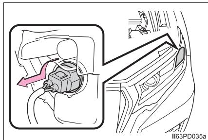
**4** 電球を取りはずす
