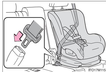
**[4] チャイルドシートにシートベルトの固定装置が備っていない場合は、ロッキングクリップ（別売）を使用して固定する**
