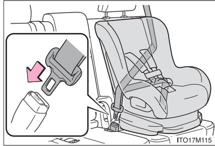
**4** チャイルドシートにシートベルトの固定装置が備っていない場合は、ロックングクリップ (別売) を使用して固定する
