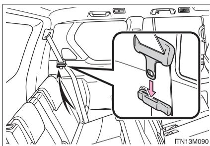
**■ 格納するには****▶ バックドア側から操作するとき****背もたれ背面のレバーを引く**
