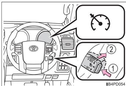
定速制御モードに切りかえると、定速制御モード表示灯が点灯します。
