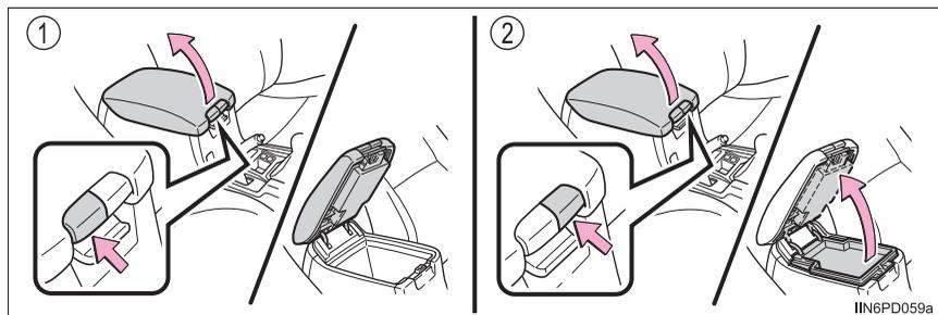
左右いずれかのノブを引き上げてロックを解除し、フタを持ち上げて開く
