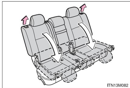
**サードシートの格納 (サードマニュアルシート装着車)****■ 格納する前に****ヘッドレストを下げる**
