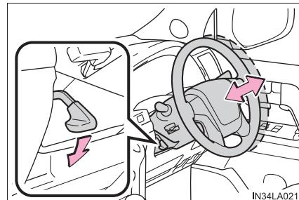
▶ 電動チルト&テレスコピックステアリング
