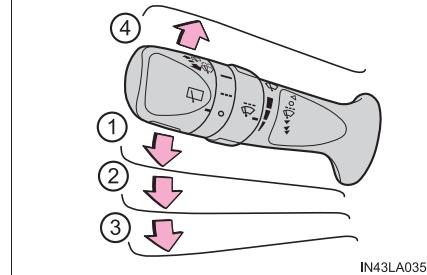
間欠作動が選択されているときは、次のようにツマミをまわして間欠時間調整できます。
